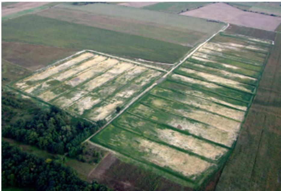
Fotografia 65. Poletka filtracyjne doczyszczające ścieki ze Sławy.
