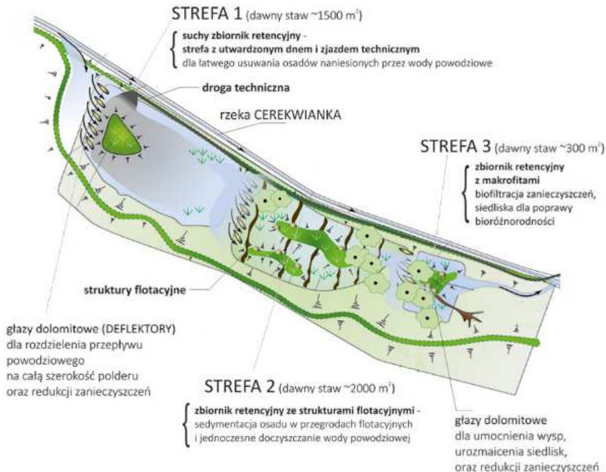
Rysunek 59. Rozwiązania zastosowane na polderze zalewowym rzeki Cerekwianki w ramach przedsięwzięcia „Adaptacja do zmian klimatu poprzez zrównoważoną gospodarkę wodą w przestrzeni miejskiej Radomia.
