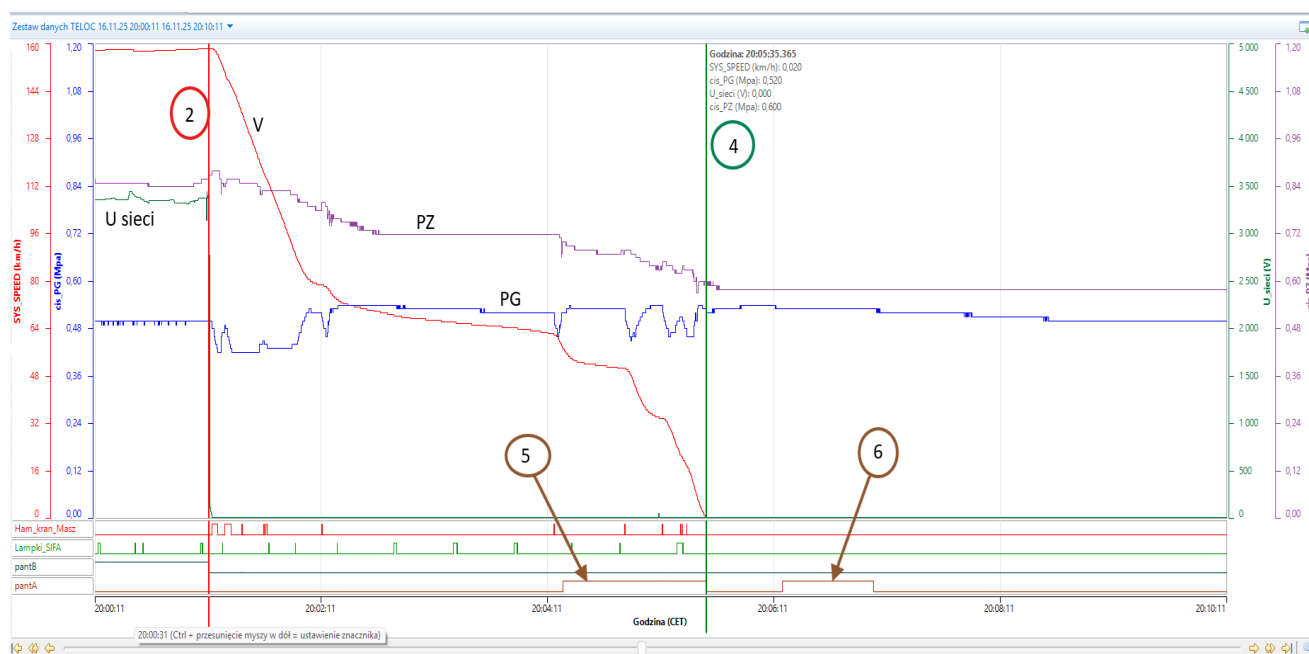
Rysunek 5. Wykres parametrów jazdy pojazdu kolejowego lokomotywy EU160-016 (opracowanie PKBWK)
