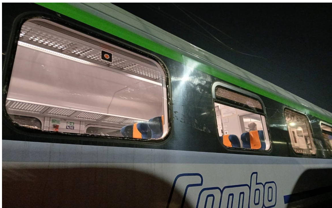
Zdjęcie 7. Widok uszkodzeń powstałych na wagonie (źródło: komisja kolejowa)
