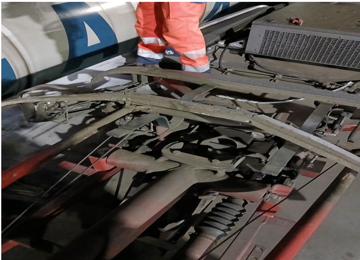
Zdjęcie 6. Widok uszkodzonego pantografu lokomotywy EU160-016 (źródło: komisja kolejowa)
