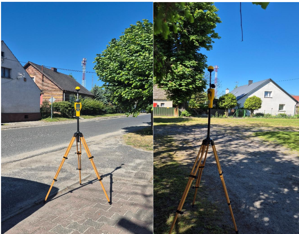
Fotografia 2.1. – 2.2. Pomiary pól elektromagnetycznych miernikiem Narda NBM-550 (źródło: CLB Oddział w Zielonej Górze)
