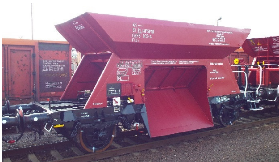
Rys. 2-123 Wagon samowyładowczy Flls (WPS/PL)
