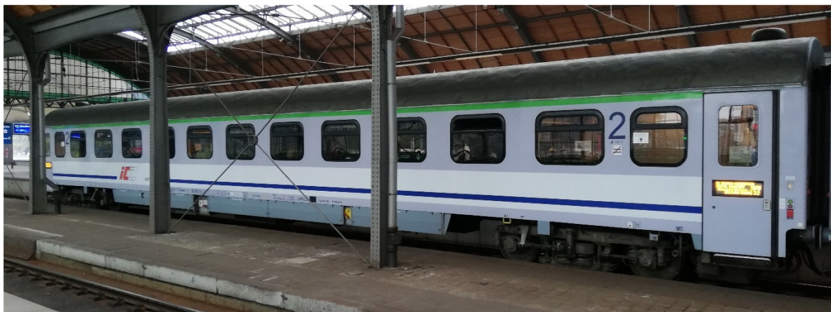
Rys. 2-46 Wagon osobowy 2 klasy serii B11mnouz typu 170A (PKP Intercity)
