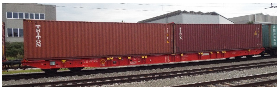
Rys. 2-138 Wagon platforma do przewozu kontenerów Sggnss (RailCargo Group/SK)
