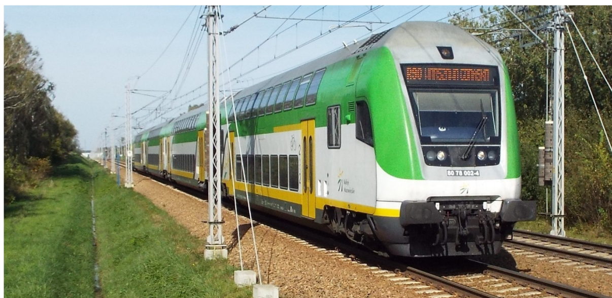
Rys. 2-47 Skład złożony z wagonów piętrowych Bombardier Twindexx: na czole wagon osobowy 1/2 klasy serii AB12bfmnpuvxz (sterowniczy), w składzie wagony 2 klasy serii B16mnopuxz (Koleje Mazowieckie).
