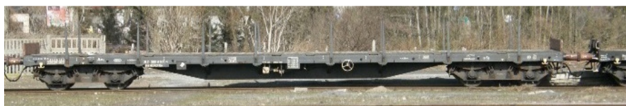
Rys. 2-135 Wagon platforma Rs (PKP Cargo/PL)
