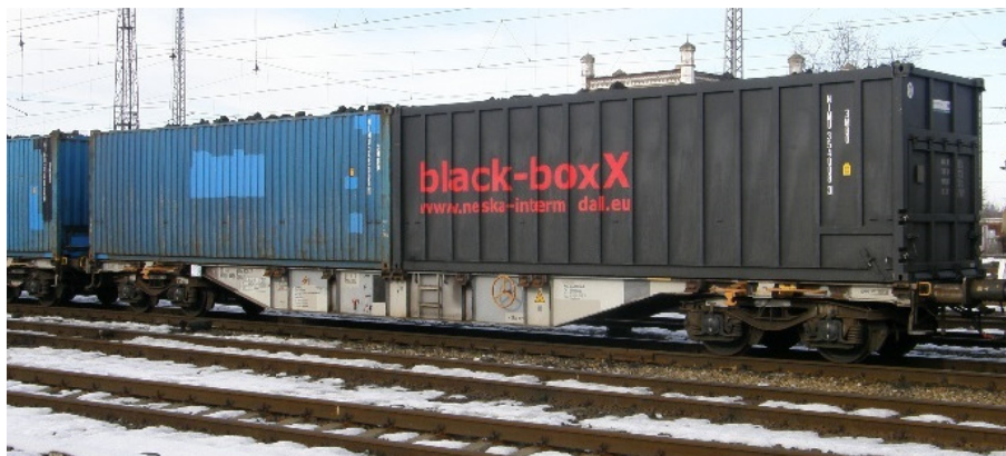
Rys. 2-139 Wagon platforma do przewozu kontenerów Sgns (AAE/D)
