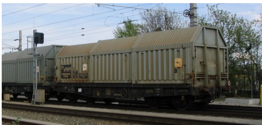
Rys. 2-140 Wagon platforma budowy specjalnej Shimms (PKP Cargo/PL)
