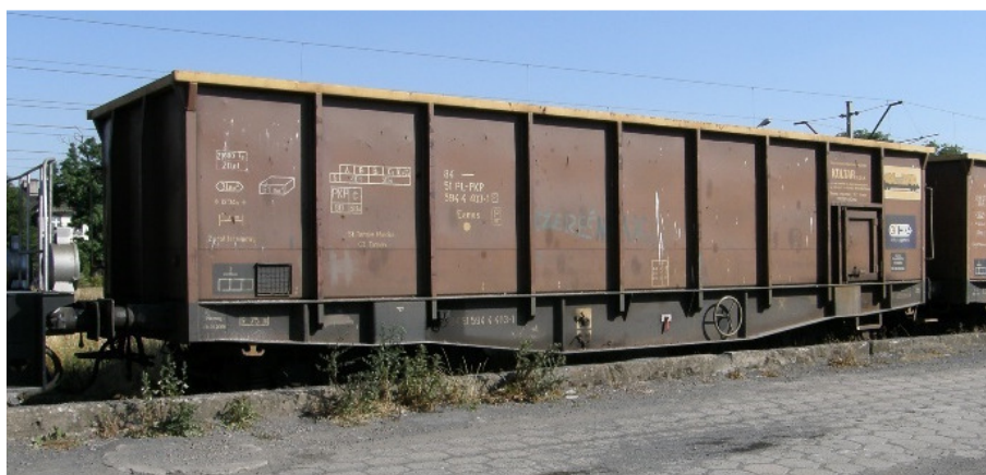
Rys. 2-129 Wagon otwarty Eamos (Koltar/PL)
