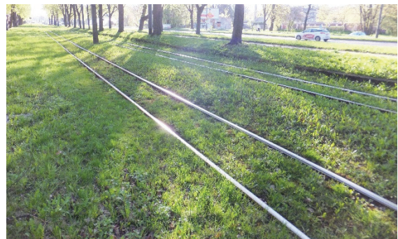
Rys. 3-91 Poligon badań hałasu tramwajowego na torowisku tradycyjnym – rozstaw szyn 1000 mm (deskryptor torowiska CNOSSOS: BMNNNN)
