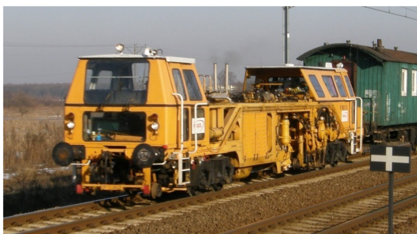
Rys. 2-148 Podbijarka torowa PR-07 (DOLKOM)
