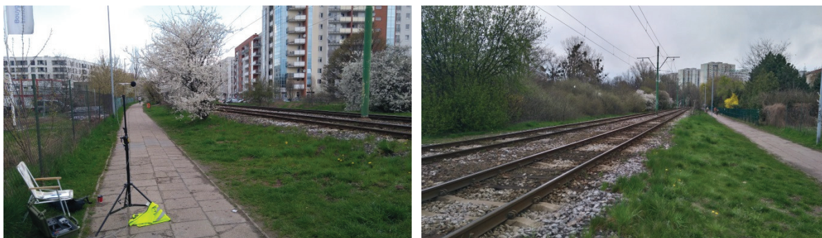
Rys. 3-88 Poligon badań hałasu tramwajowego na torowisku tradycyjnym – rozstaw szyn 1435 mm (deskryptor torowiska CNOSSOS: BMNNNN)
