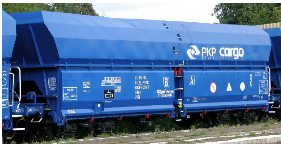
Rys. 2-133 Wagon samowyładowczy Falns (PKP Cargo/PL) tzw. Talbot
