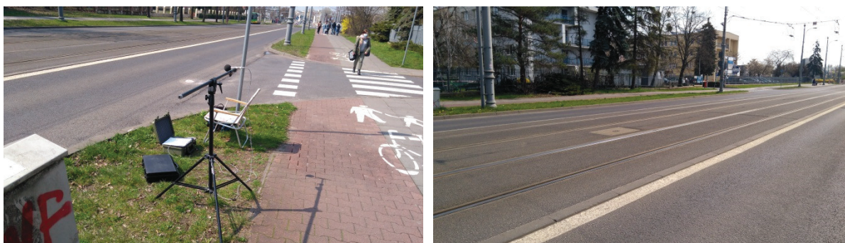
Rys. 3-87 Poligon badań hałasu tramwajowego na torowisku zabudowanym – rozstaw szyn 1435 mm (deskryptor torowiska CNOSSOS: TMNNNN)
