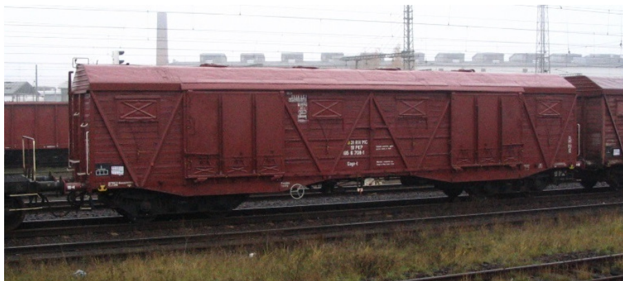
Rys. 2-134 Wagon kryty budowy normalnej Gags (PKP Cargo/PL)
