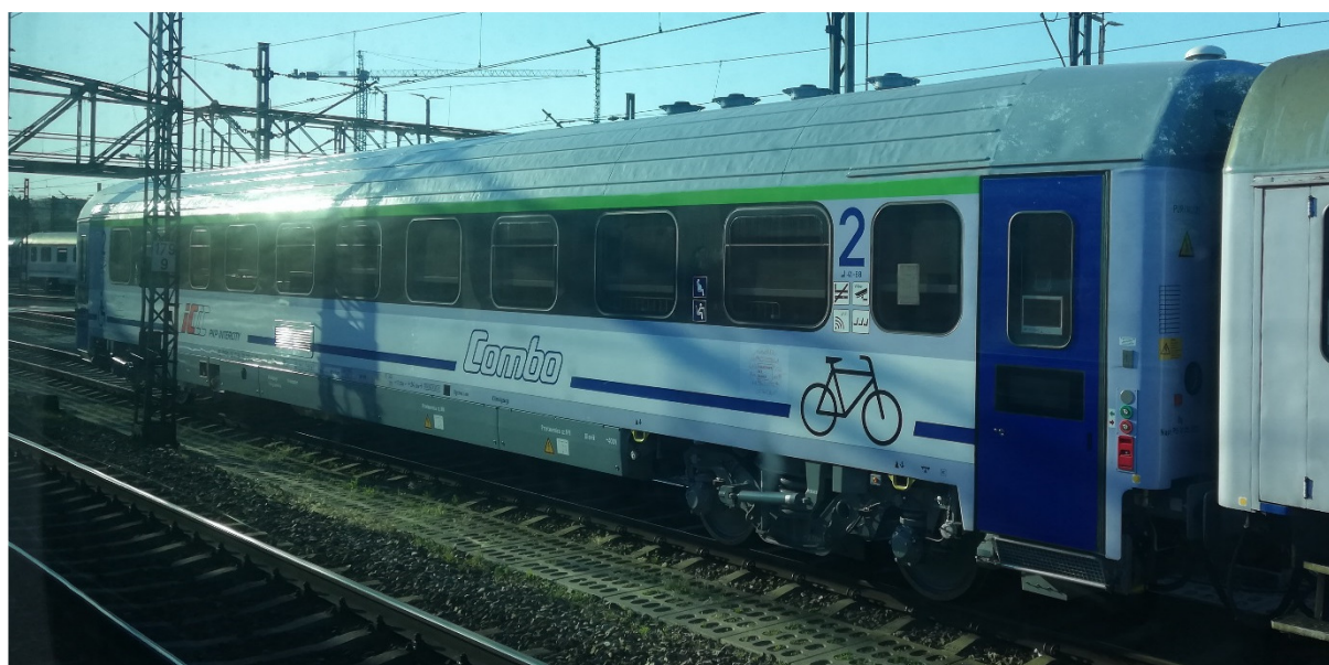
Rys. 2-45 Wagon osobowy 2 klasy serii B6bnouvz typu 111A-30 (PKP Intercity)
