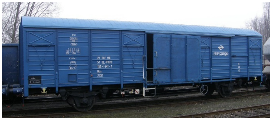
Rys. 2-124 Wagon kryty Gbs (PKP Cargo/PL)
