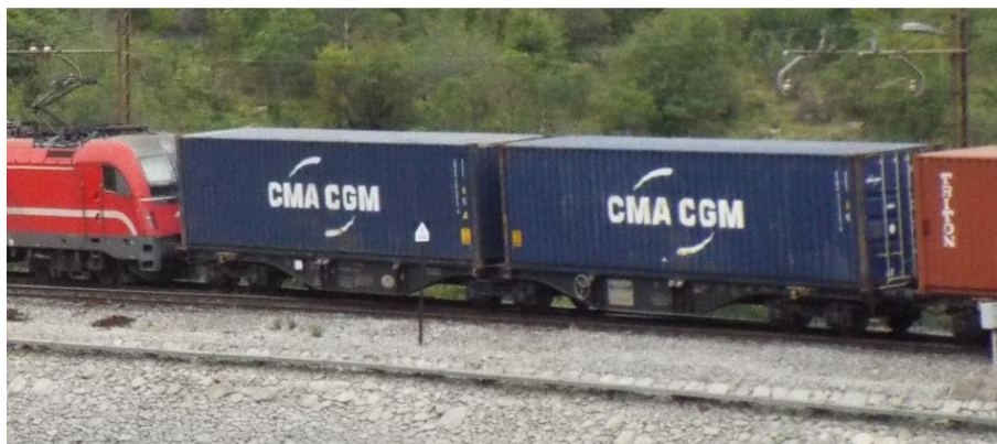
Rys. 2-144 Platforma budowy specjalnej Sggms (przewoźnik niezidentyfikowany, wagon odpowiada budową wagonom eksploatowanym przez PKP Cargo)
