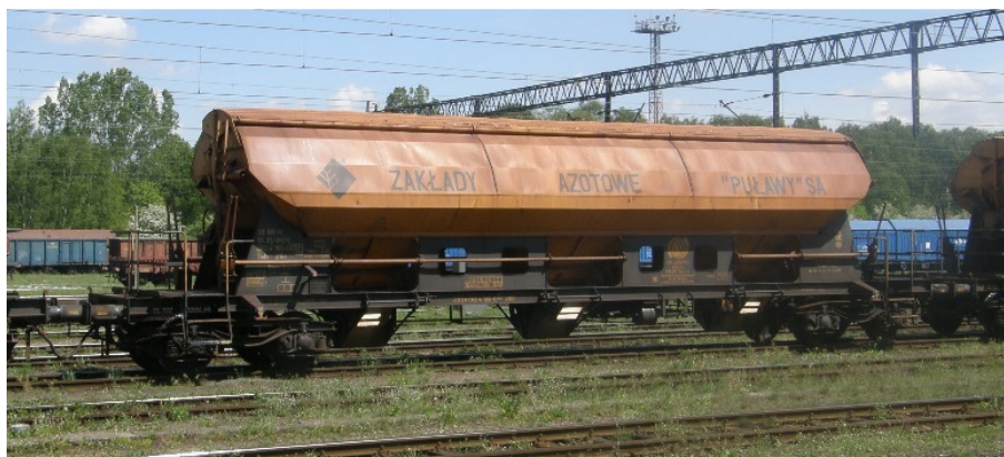
Rys. 2-141 Wagon z otwieranym dachem Tads (PKP Cargo/PL)
