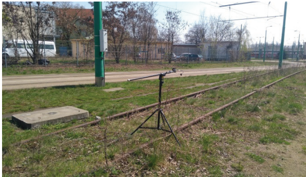
Rys. 3-89 Poligon badań hałasu tramwajowego na torowisku zabudowanym z szyną w otulinie tłumiącej hałas – rozstaw szyn 1435 mm (deskryptor torowiska CNOSSOS: TMNMNN)
