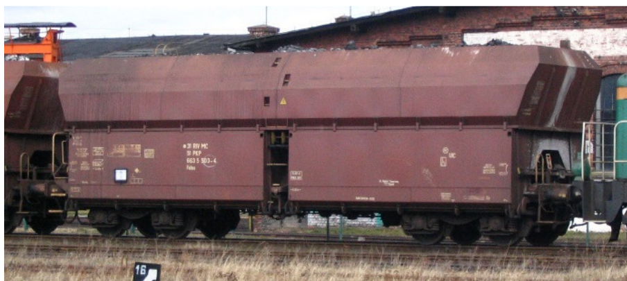
Rys. 2-132 Wagon samowyładowczy Fals (PKP Cargo/PL) tzw. Talbot
