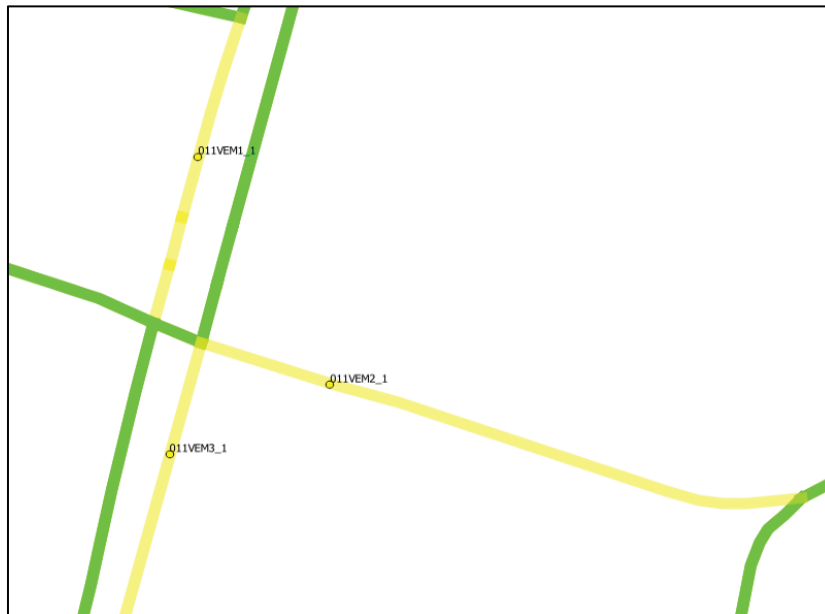
Rys. 5-3 Odcinki jednorodne (kolor żółty), dla których przypisano wartości natężenia ruchu z odpowiadających im pól detekcji
