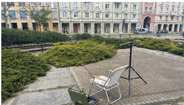
Rys. 3-90 Poligon badań hałasu tramwajowego na torowisku tradycyjnym o krzywiznie łuku r < 300\text{m} – rozstaw szyn 1435 mm (deskryptor torowiska CNOSSOS: BMNNHN)
