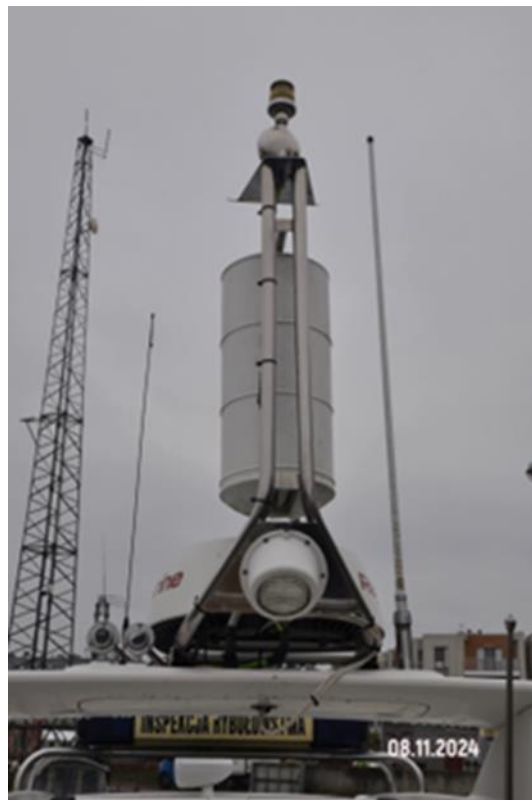
Foto nr 5 Łódź „KONTROLER -16” w Kątach Rybackich Maszt nawigacyjno - sygnałowy
