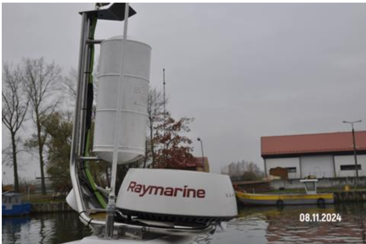
Foto nr 6 Łódź „KONTROLER -16” w Kątach Rybackich Maszt nawigacyjno - sygnałowy
