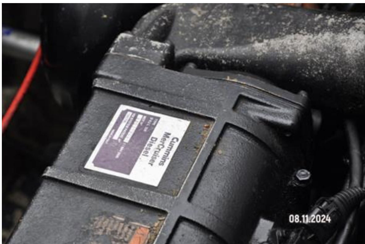
Foto nr 20 Łódź „KONTROLER -16” w Kątach Rybackich Blok silnika z tablicą znamionową
