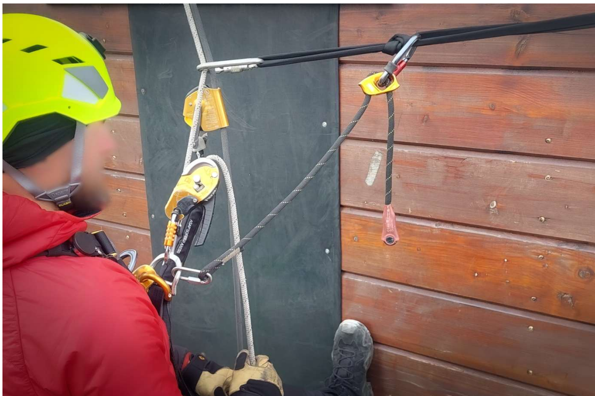
Rysunek 5 Odciąg, zjazd – przepięcie
