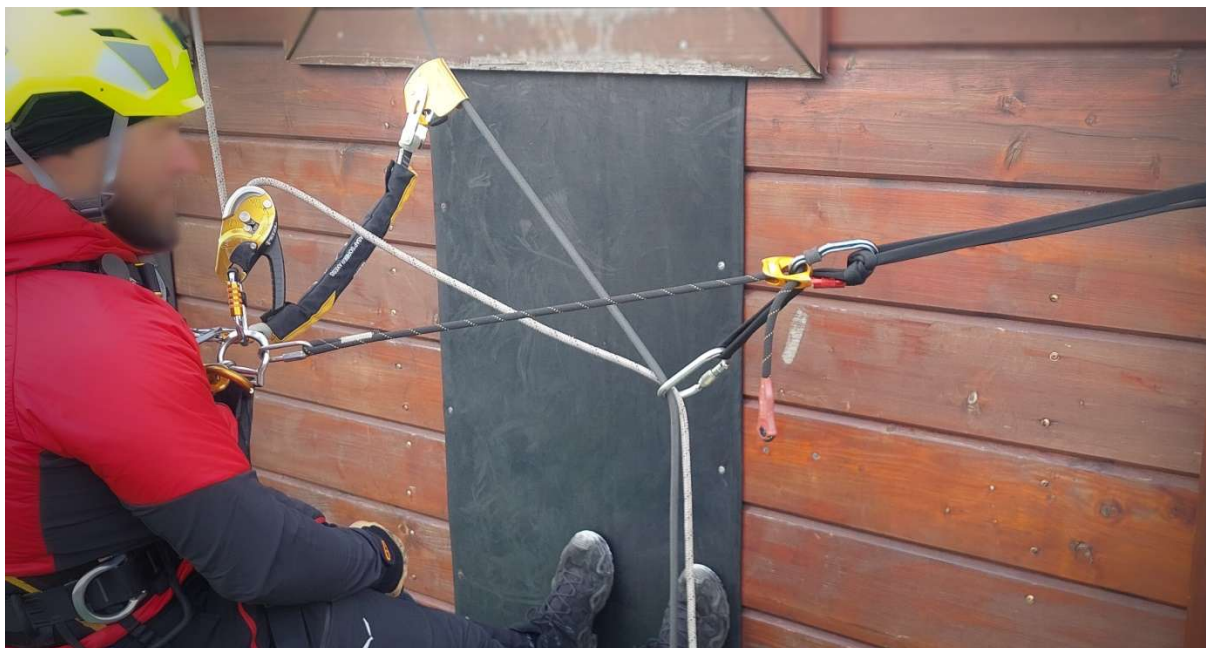
Rysunek 4 Odciąg, zjazd – wpięcie lonży
