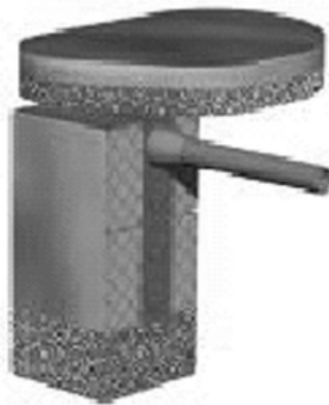
Rys. 4.18. Studnia chłonna wykonana ze skrzynek rozsączających [39]
