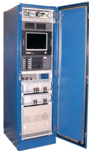
Rys. 4. DMOS – Digital Multi-Camera Optical Surveillance System z możliwością rejestracji danych z szesnastu kamer oddalonych od nich rejestratorem. System jest odpowiednikiem systemu MIVS (źródło: [6]).
