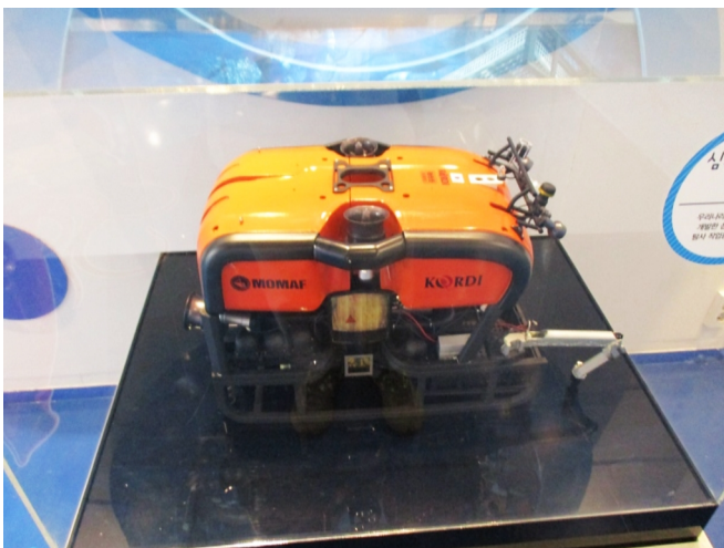
Fot. 2. Ten robot służy do badań podwodnych, ale jego odpowiedniki badają zbiorniki reaktorów jądrowych. Korea Południowa. Daejon (zdjęcie własne autora).
