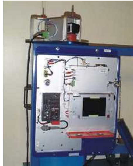
Rys. 3. DSOS – Digital Single – camera Optical kamera połączona jest specjalnym kablem z oddalonym od niej rejestratorem. System jest odpowiednikiem systemu (źródło: [6]).
