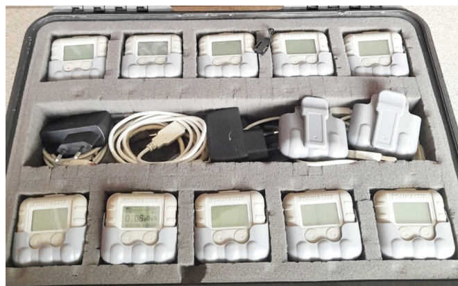
Rys. 1. Elektroniczne dawkomierze indywidualne znajdujące się w wyposażeniu PSP (źródło: archiwum prywatne autorów).
