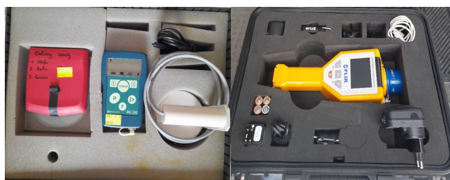
Rys. 3. Przyrządy radiometryczne przeznaczone do pomiaru mocy dawki promieniowania jonizującego znajdujące się w wyposażeniu PSP (źródło: archiwum prywatne autorów).
