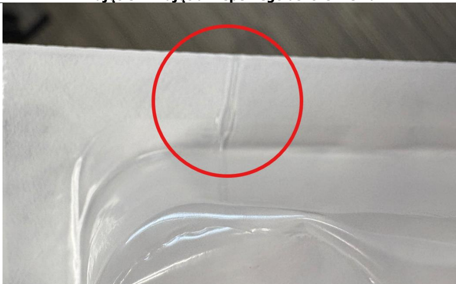
Zdjęcie 1: Zdjęcia niepełnego uszczelnienia
