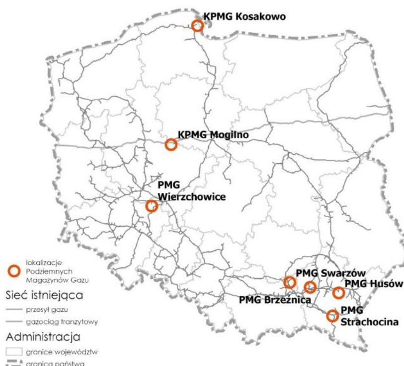
Rysunek 15. Mapa rozmieszczenia podziemnych magazynów gazu ziemnego wysokometanowego w Polsce
