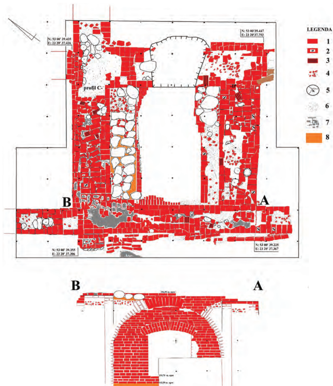
11. Zabłudów, pow. białostocki. Plan i profil (B-A) piwnicy budynku dworskiego. Legenda: 1 – cegła, 2 – cegła z symbolem „S”, 3 – cegła palcówka, 4 – gruz ceglany, 5 – kamień, 6 – zaprawa wapienna, 7 – zaprawa cementowa, 8 – piasek. Rys. L. Pawlata Zabłudów, Białystok County. The plan and profile (B-A) of the manor building basement. Legend: 1 – brick, 2 – brick with an “S” symbol, 3 – Gothic “finger” brick, 4 – brick rubble, 5 – stone, 6 – lime mortar, 7 – cement mortar, 8 – sand. Sketch by L. Pawlata
