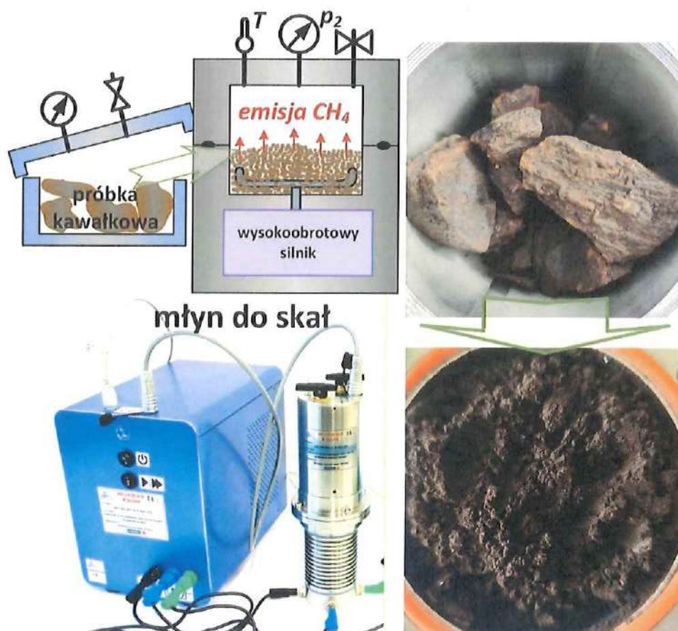
Rysunek 7 Schemat i zdjęcie młyna do skał oraz próbki węgla brunatnego przed i po rozdrobnieniu (etap 3)
