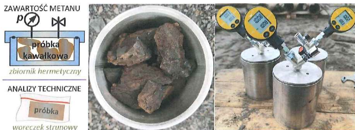
Rysunek 5 Schemat i zdjęcia hermetycznego zbiornika na próbkę węgla brunatnego (etap 1)
