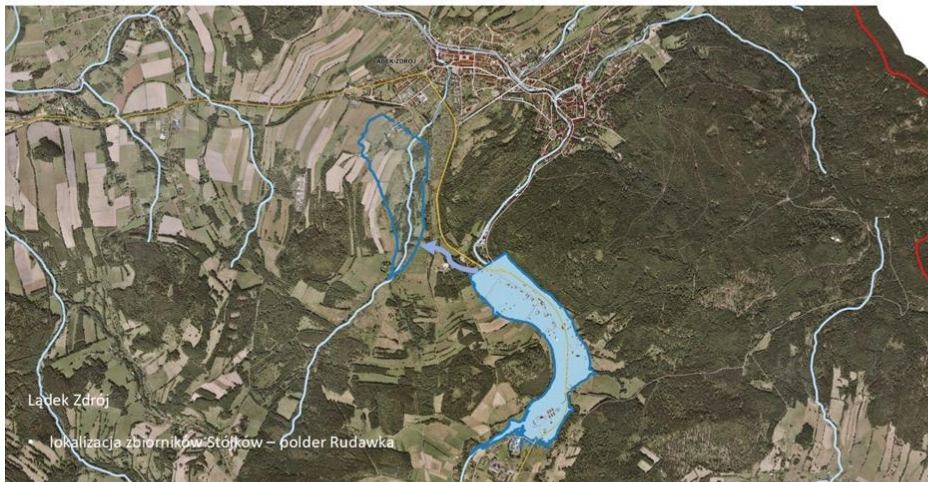
Rysunek 9.1.15 Schemat przerzutu wody ze zbiornika Stójków do Polderu Rudawka
