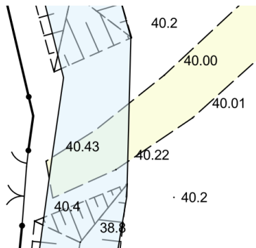
Rysunek. Fragment pliku GML, w którym zaobserwowano nakładanie się jezdni na rów przydrożny (działka numer 321003_4.0004.448)
