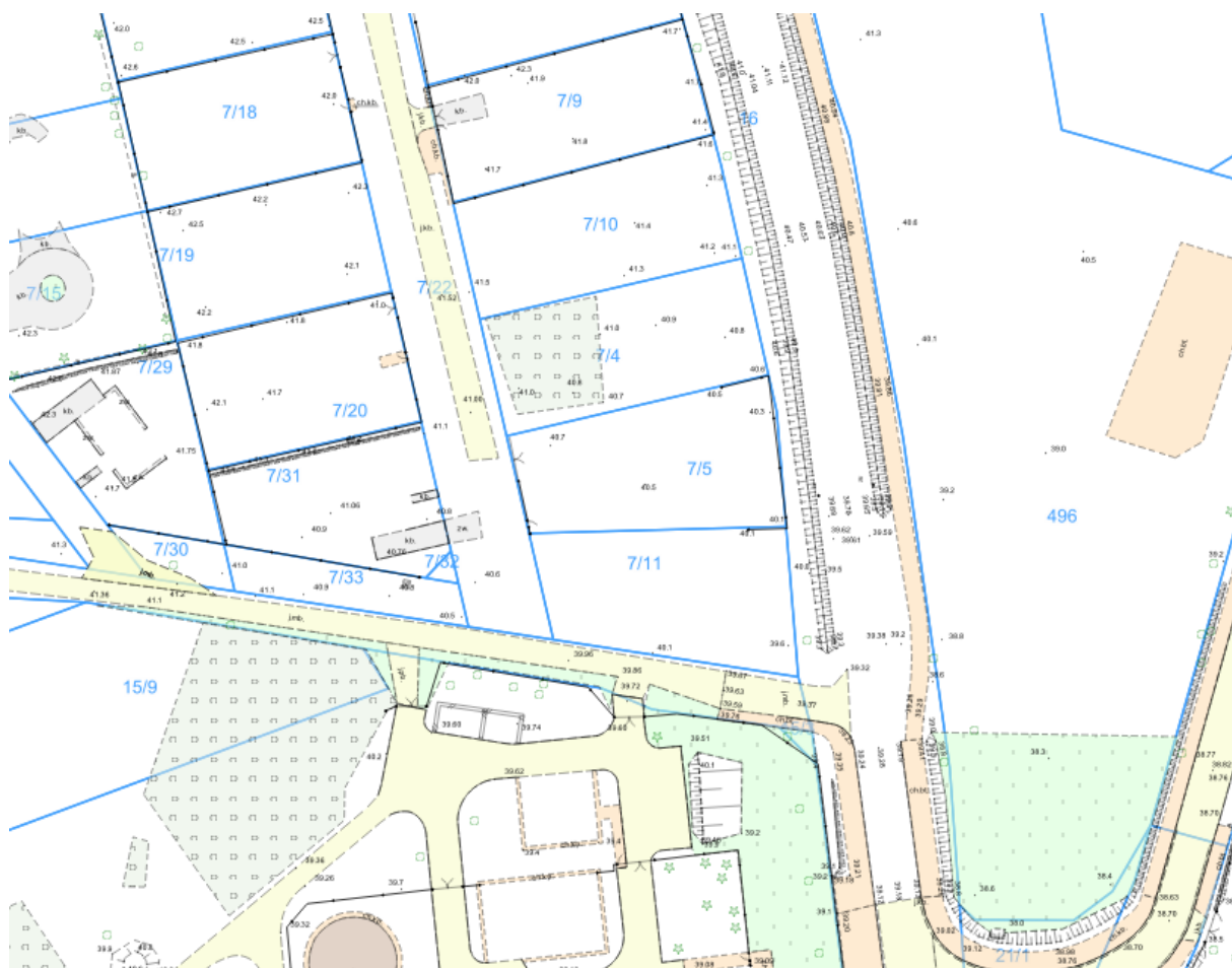
Rysunek. Fragment pliku GML, w którym zaobserwowano brak ciągłości obiektu jezdni (działka numer 321003_4.0004.16)
