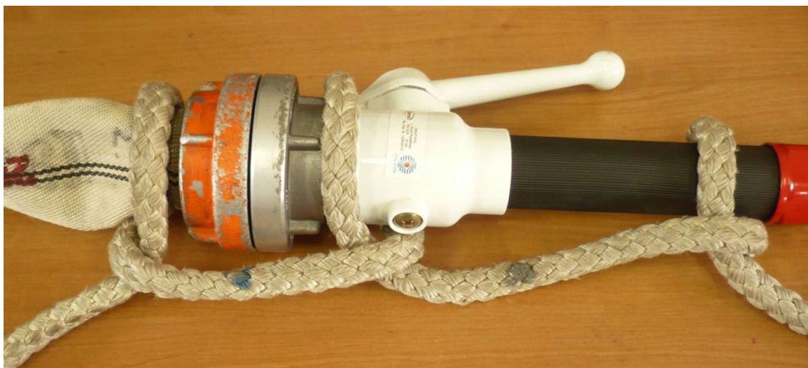
Nieprawidłowo. Brak pełnej pętli na prądownicy.
