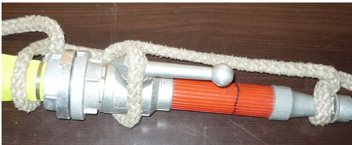
Nieprawidłowo. Linka na zaworze.
