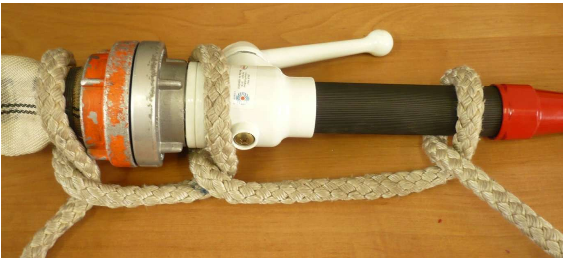
Nieprawidłowo. Brak pełnej pętli na prądownicy. Ułożenie linki na zaworze dopuszczalne.
