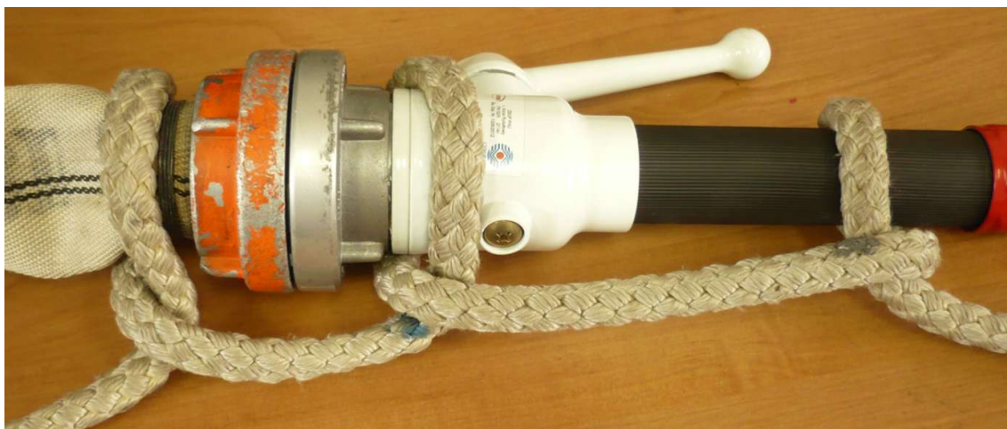
Prawidłowo. Jest pętla na prądownicy, jest półpętla na wężu. Ułożenie linki na zaworze dopuszczalne.
