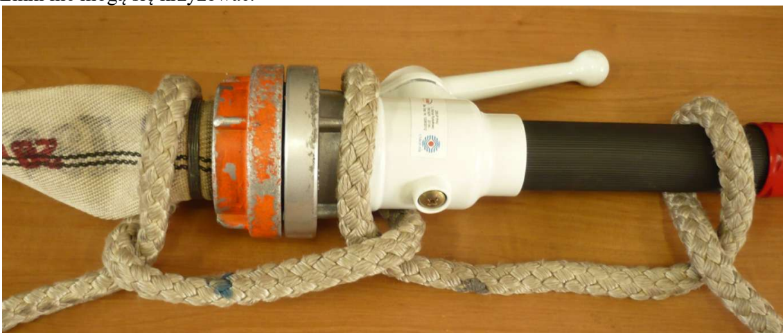
Prawidłowo. Jest pętla na prądownicy, jest półpętla na węź. Linka nie leży na łączniku.
