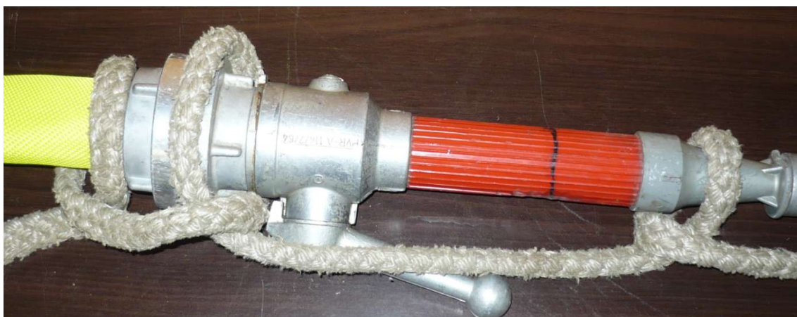
Nieprawidłowo. Linka na łączniku.
