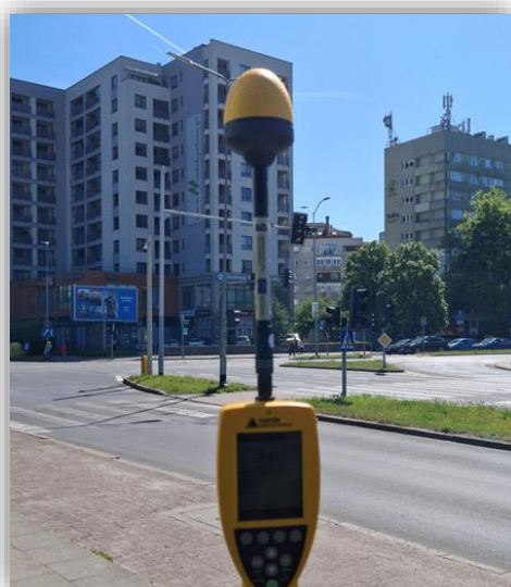
Fotografia 2.1. Pomiar pól elektromagnetycznych miernikiem Narda NBM-550 - punkty: Z_2021_A_6, Z_2025_GW_5, Z_2021_A_1, Z_2021_E_6 (źródło: CLB Oddział w Szczecinie)
