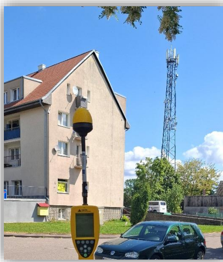
Fotografia 2.1. Pomiar pól elektromagnetycznych miernikiem Narda NBM-550 - punkty: Z_2021_A_6, Z_2025_GW_5, Z_2021_A_1, Z_2021_E_6 (źródło: CLB Oddział w Szczecinie)
