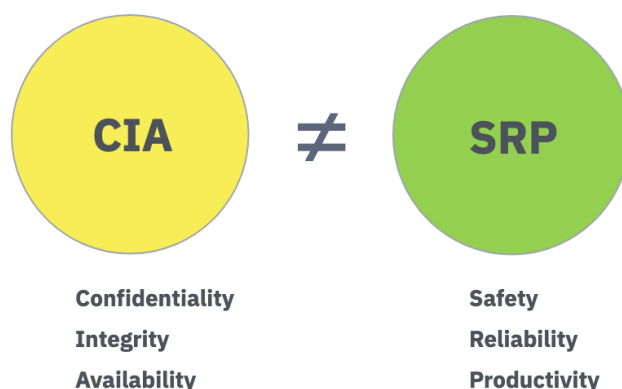
Rysunek 1. Porównanie priorytetów bezpieczeństwa w środowiskach IT (CIA) i OT (SRP)
