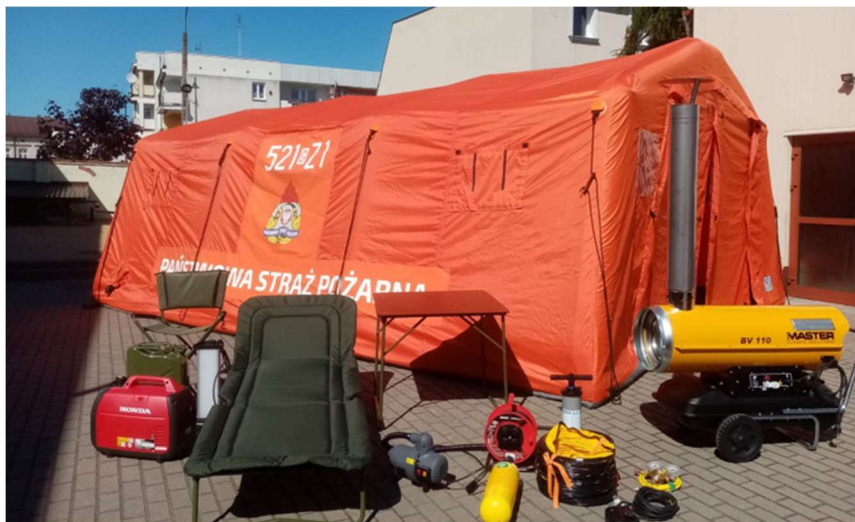
rys. 282 Ogrzewany punkt do przebierania i odpoczynku przeznaczony dla nurków https://www.gov.pl
