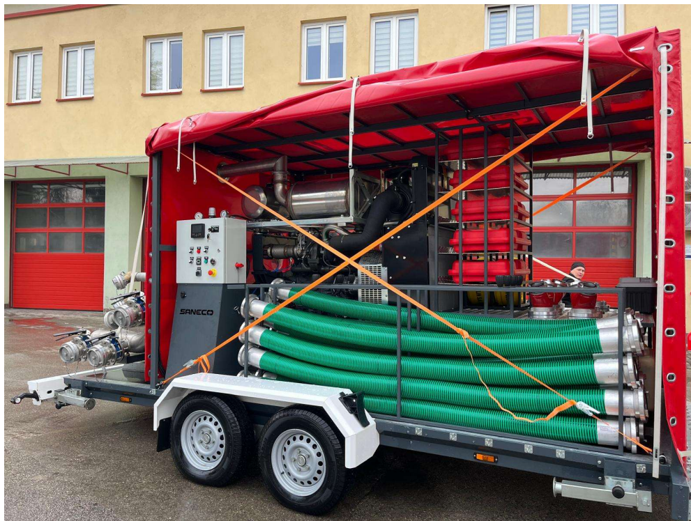
Zdjęcie 44 - Przyczepa pompowa M80/8 SANECO do wody czystej i zanieczyszczonej – Zbiornik na olej napędowy o pojemności 5000L – wartość 23.940,72 zł
