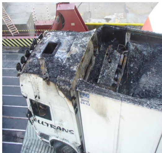
Zdjęcie nr 6. Samochód, którego urządzenie chłodnicze było źródłem powstania pożaru na „STENA SPIRIT” (WIM 60/16)
