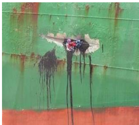
Zdjęcie nr 12. Uszkodzone (przebite) poszycie kadłuba statku „Green Egersund” (WIM 39/15)
