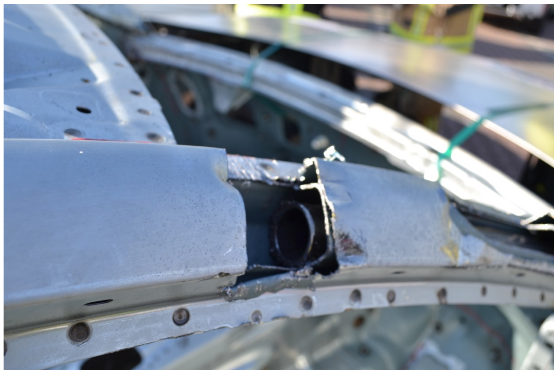
Rys. 55. Wzmocnienie słupka A, które mogłoby uniemożliwić przecięcie nożycami
