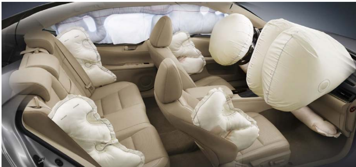
Rys. 62. Przykładowe umiejscowienie poduszek bezpieczeństwa.
