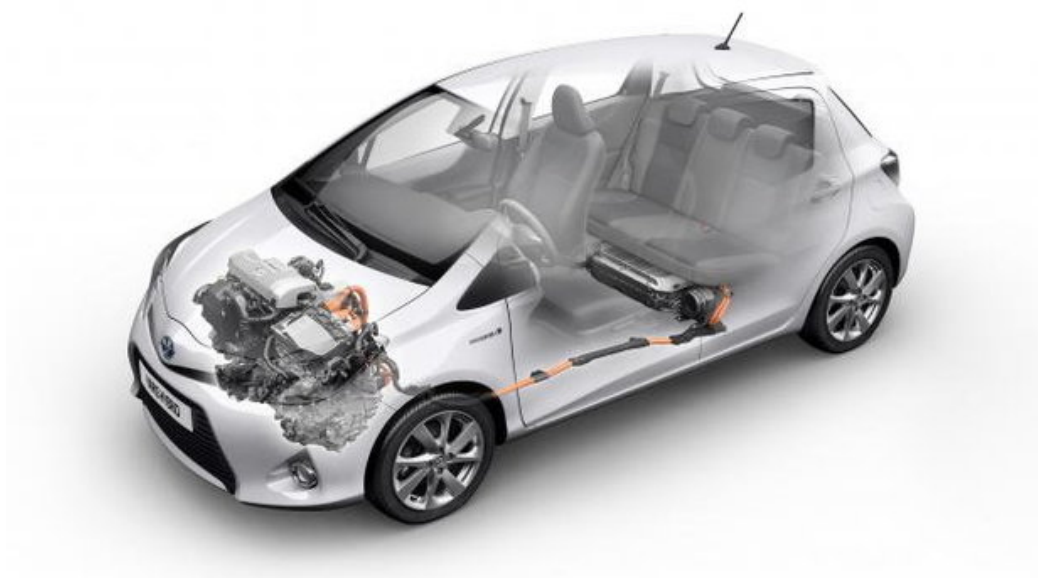
Rys. 78. Układ hybrydowy na przykładzie Toyoty Prius
