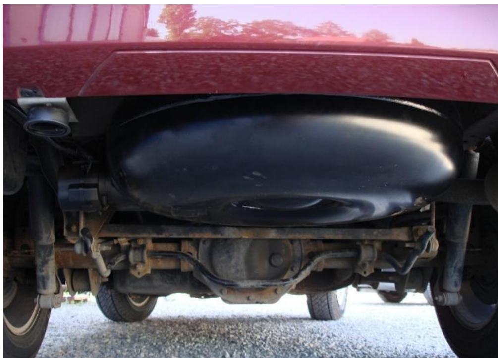
Rys. 70. Zbiornik toroidalny, umiejscowiony pod pojazdem Źródło: http://autogazaries.pl/jeep-liberty-3-7-211km,587
