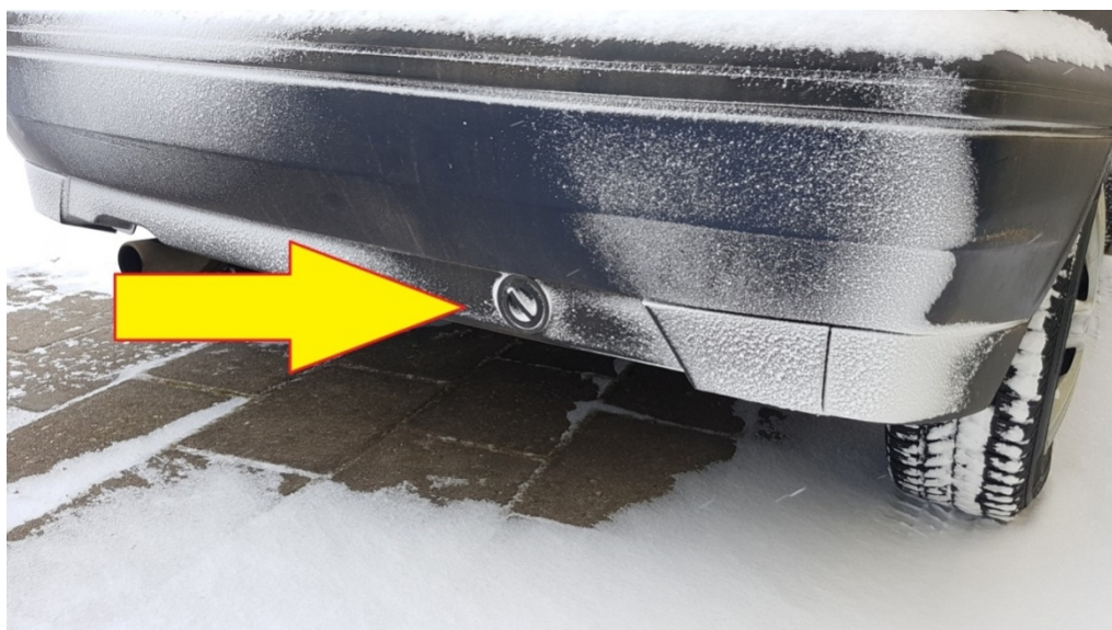
Rys. 72. Umiejscowienie króćca wlewowego gazu z tyłu pojazdu
