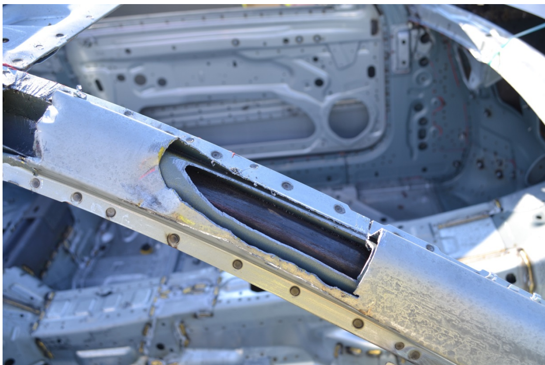
Rys. 54. Wzmocnienie słupka A, które mogłoby uniemożliwić przecięcie nożycami
