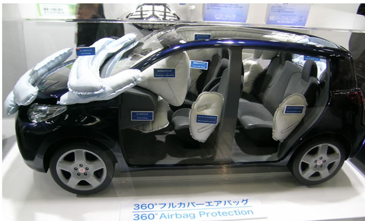
Rys. 63. Widoczne zewnętrzne poduszki bezpieczeństwa zastosowane przez markę Toyota
