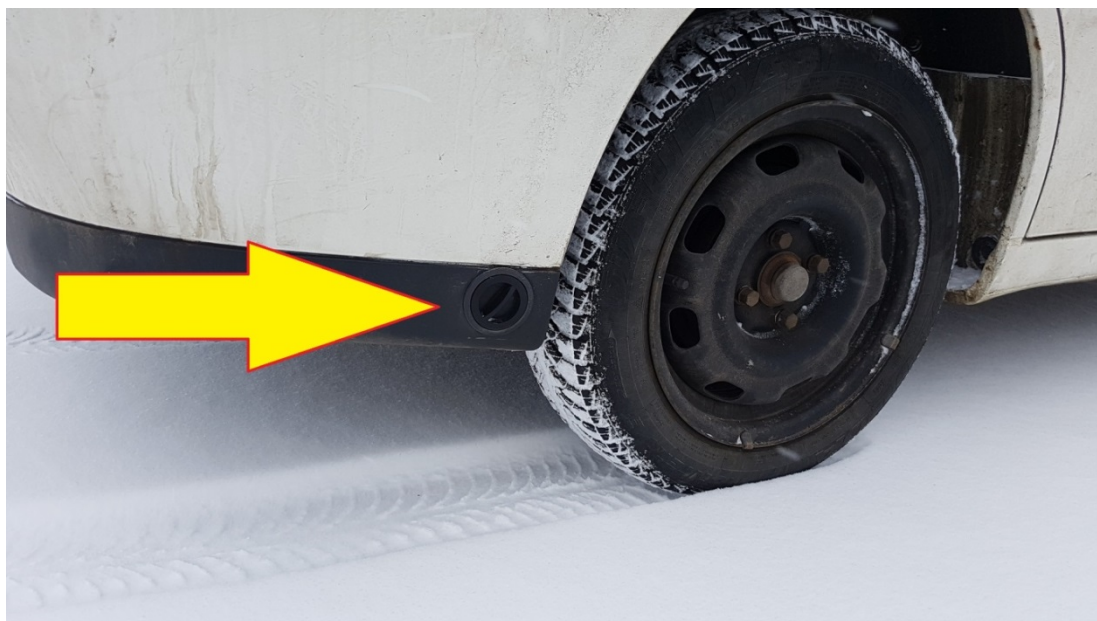
Rys. 73. Umieszczenie króćca wlewowego gazu z boku pojazdu
