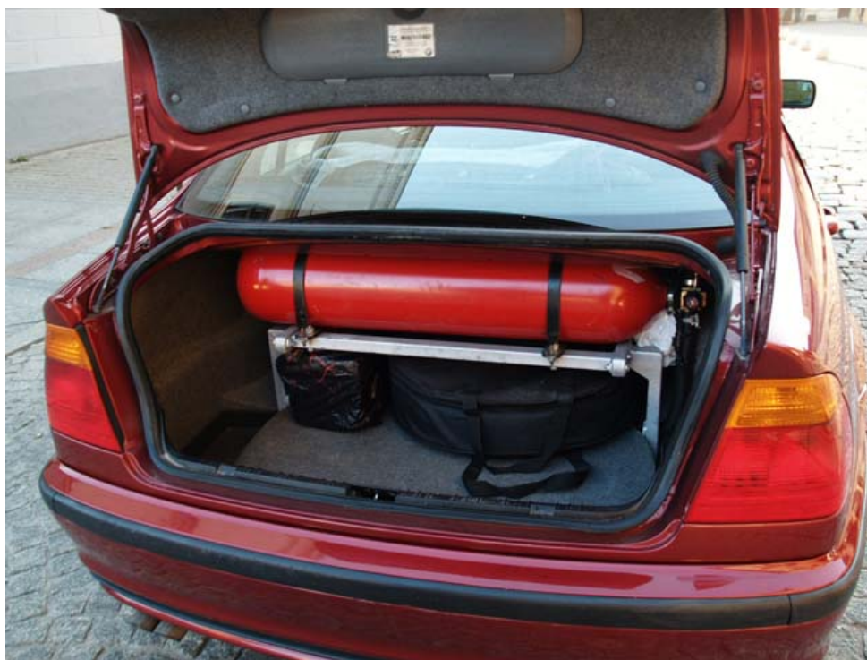
Rys. 75. Zbiornik CNG w bagażniku auta
