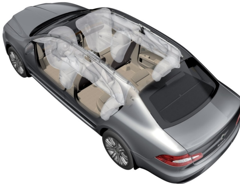
Rys. 61. Umiejscowienie poduszek bezpieczeństwa. Skoda Octavia 2016 r.
