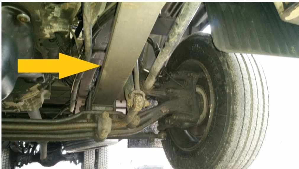
Rys. 98. Amortyzacja mechaniczna –za pomocą resora
