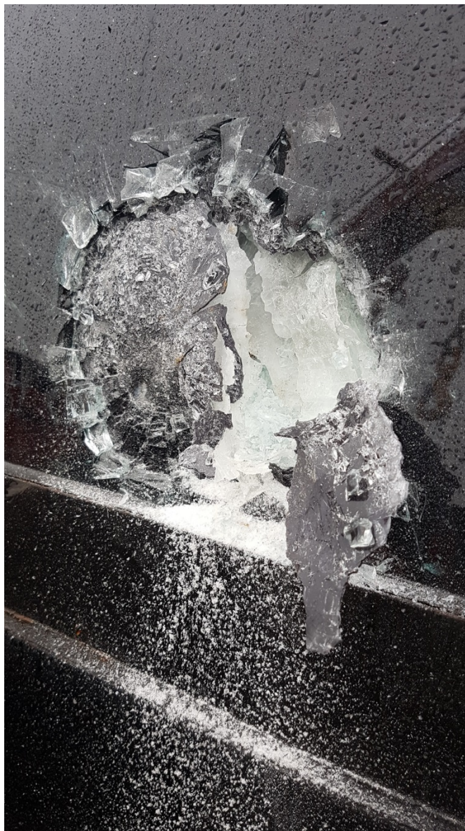
Rys. 67. Kilkanaście silnych uderzeń młotem 5 kg nie przebiło szyby pancernej
