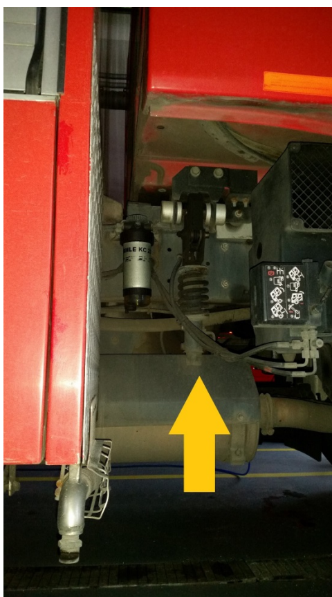
Rys. 89. Amortyzacja kabiny za pomocą sprężyn śrubowych z teleskopowymi amortyzatorami hydraulicznymi (tył)
