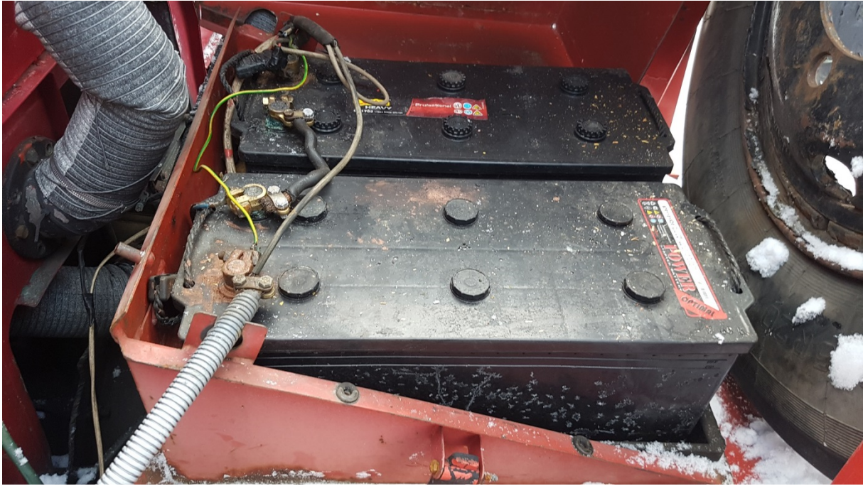
Rys. 92. Akumulatory umieszczone na ramie pojazdu, za kabiną
