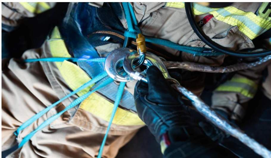
Spięcie pętli szytych i zabezpieczenie karabinka
