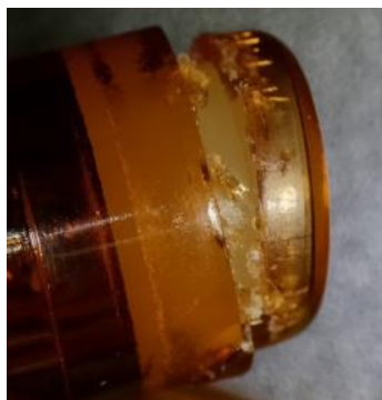
Rysunek 2 – Przykład uszkodzenia portu iniekcyjnego
