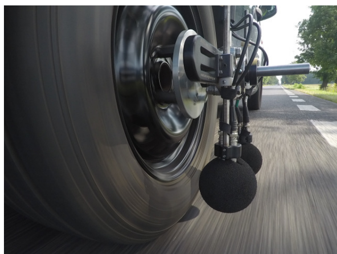
Rysunek 8. Urządzenie OBSI zamocowane na kole podczas pomiaru
