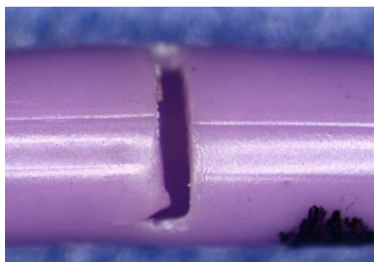
Rycina 1: Przykład pęknięcia poprzecznego/obwodowego korpusu cewnika
