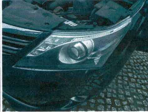
reflektor przedni z nalotem starzenia się powłoki
