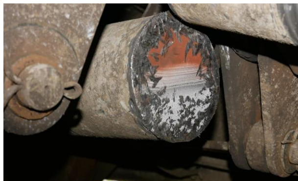
Zdjęcie 8 - Skutki zdarzenia - widok złamanej osi (źródło: materiał własny PKBWK)
