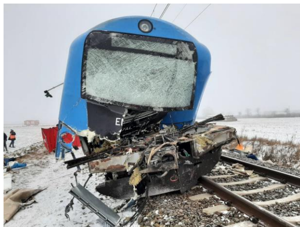
Zdjęcie 2 - Skutki zdarzenia – uszkodzony ezt EN57AL-1527 (źródło: materiał własny PKBWK)
