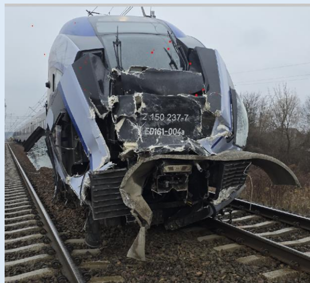
Zdjęcie 18 - Skutki zdarzenia – uszkodzona kabina ED161-004a (źródło: materiały komisji kolejowej)
