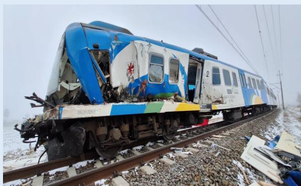
Zdjęcie 1 – Skutki zdarzenia – uszkodzony ezt EN57AL-1527 (źródło: materiał własny PKBWK)
