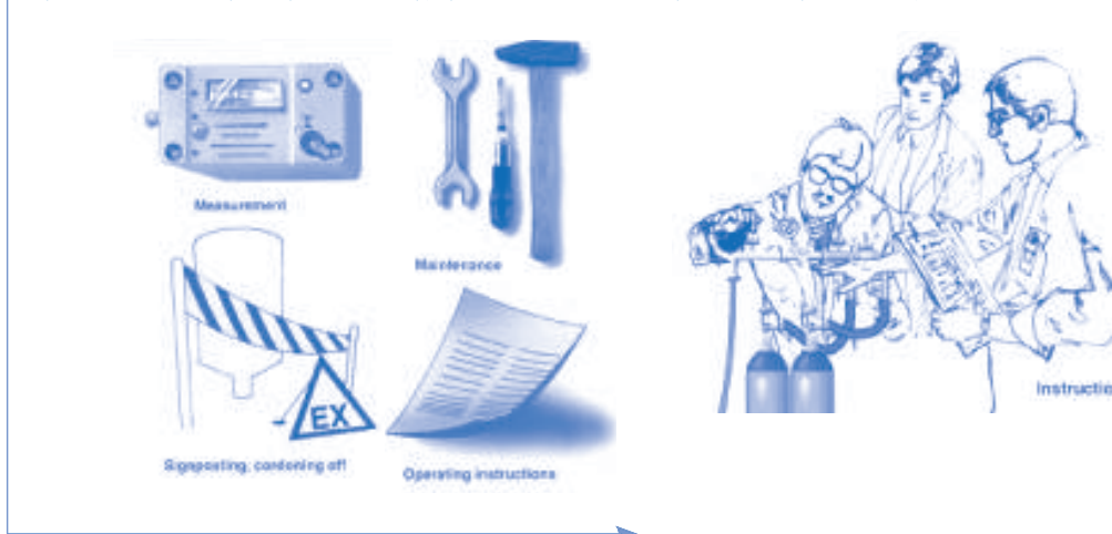
Rysunek 4.1: Przykłady organizacyjnych środków ochrony przeciwwybuchowej 12
