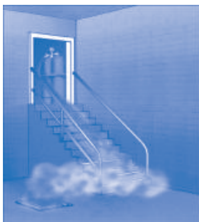
Rysunek 2.3: Rozprzestrzenianie się skroplonych gazów (przykład) 6
