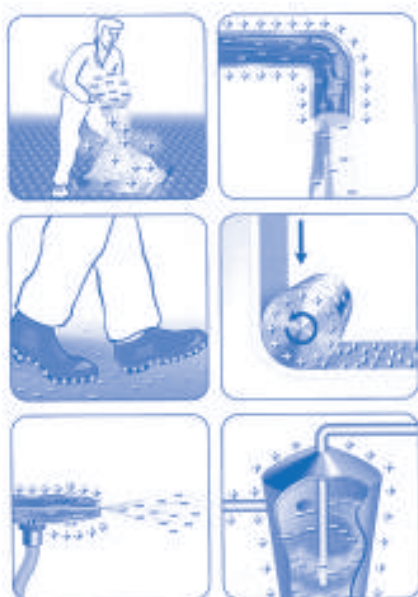
Rysunek 3.6: Przykłady rozdzielania ładunku, które może prowadzić do nagromadzenia ładunków elektrostatycznych 11 .
