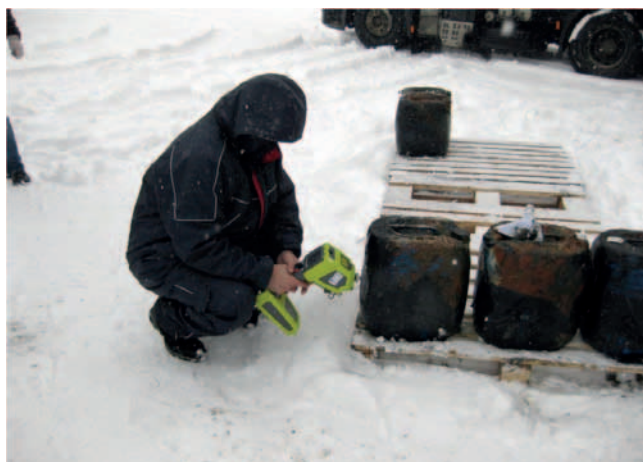
Fot. 1. Identyfikacja substancji zawartej w pojemniku przy użyciu ramanowskiego analizatora chemicznego typu StreetLab Mobile na terenie byłej Bazy Paliw w Cieszynie
