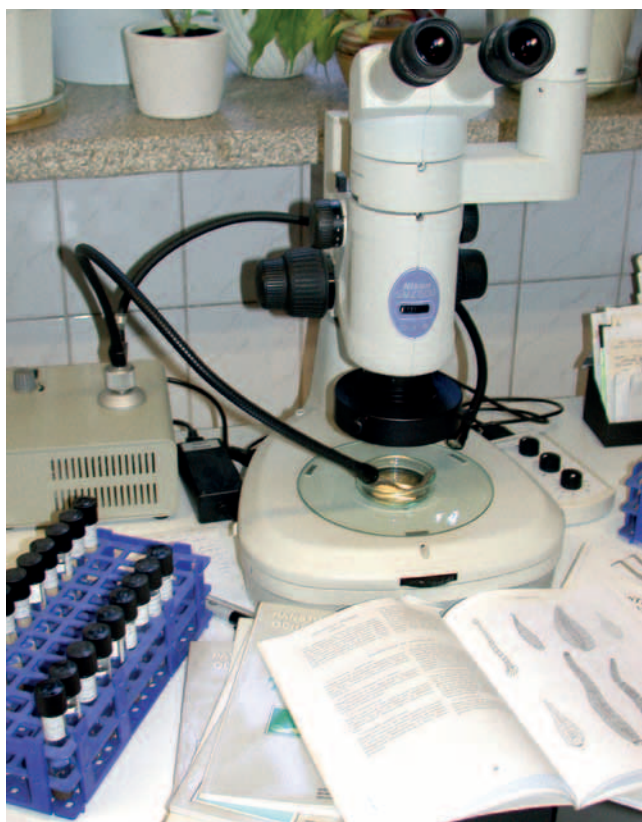
Fot. 4. Oznaczanie zoobentosu pod mikroskopem stereoskopowym
