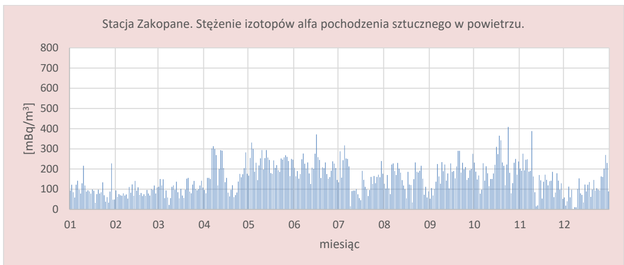
Rys.24. Stężenie promieniotwórcze izotopów alfa pochodzenia sztucznego w aerozolach na stacji Zakopane w 2024 roku
