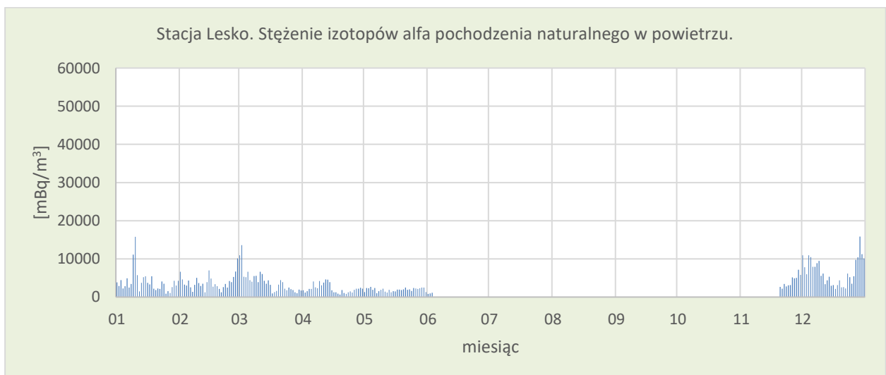
Rys.18. Stężenie promieniotwórcze izotopów alfa pochodzenia naturalnego w aerozolach na stacji Lesko w 2024 roku (brak danych 04.06-19.11.2024 – awaria aparatury)
