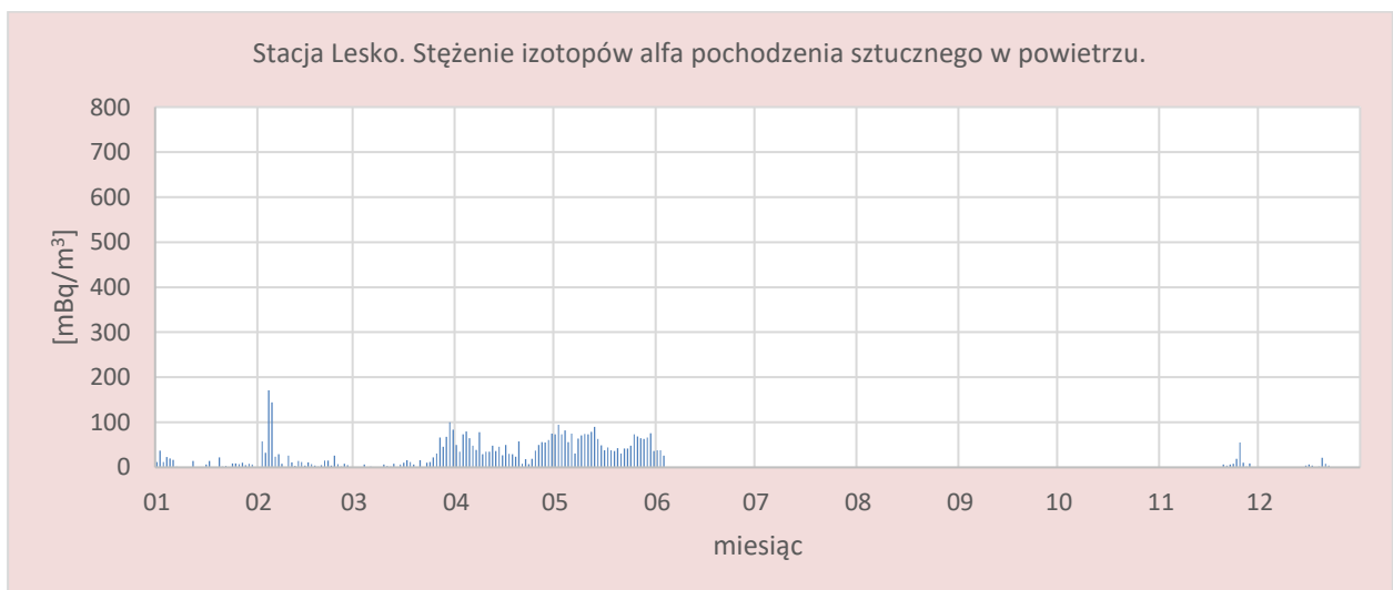
Rys.25. Stężenie promieniotwórcze izotopów alfa pochodzenia sztucznego w aerozolach na stacji Lesko w 2024 roku (brak danych 04.06-19.11.2024 – awaria aparatury)
