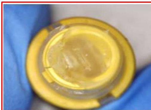
Rysunek 2: Rozdarta uszczelka silikonowa
