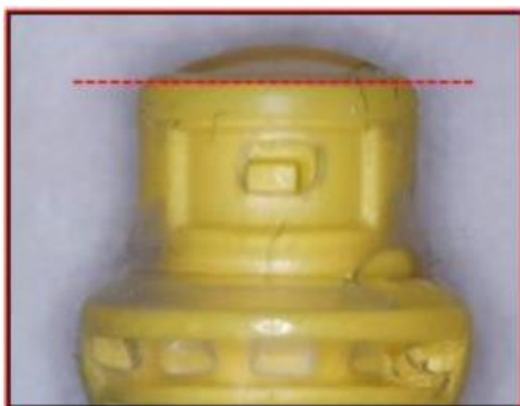
Rysunek 1: Wybrzuszona uszczelka silikonowa
