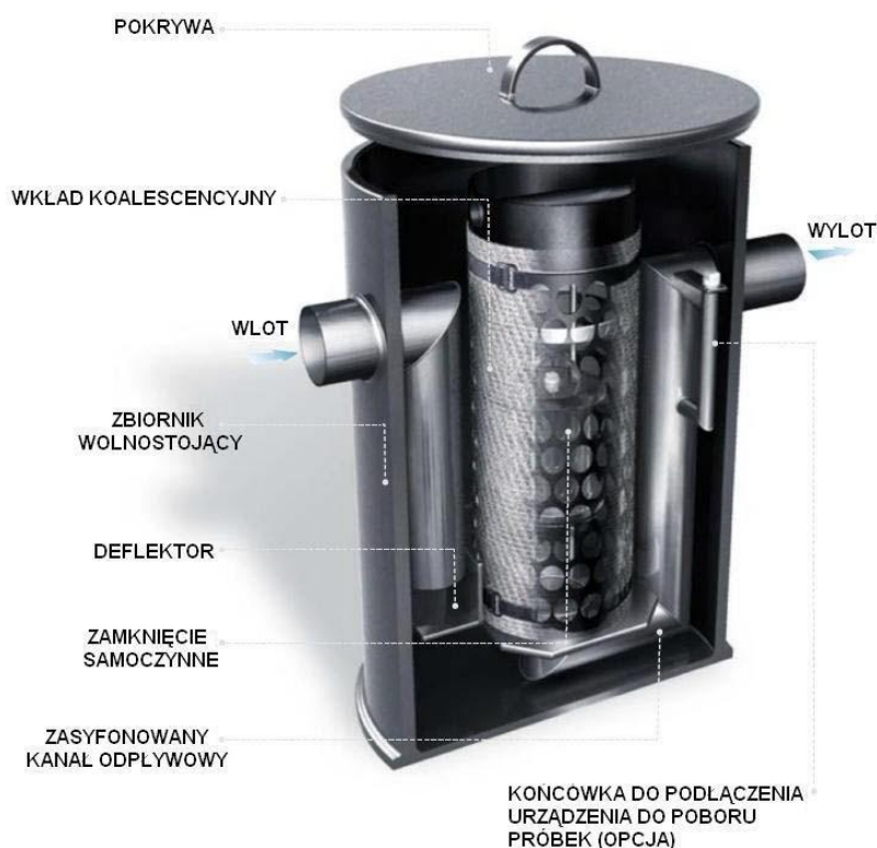
Rys. 8.5.2.2. Przykład rozwiązania separatora koalescencyjnego [21]
