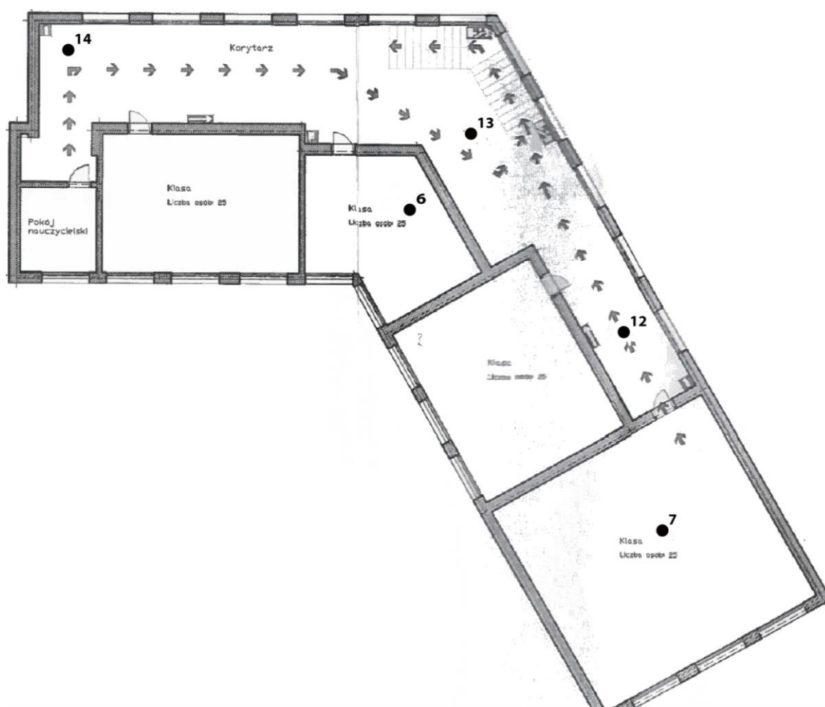
Rys. 1b: Plan rozmieszczenia punktów pomiarowych – 1 piętro, część A
