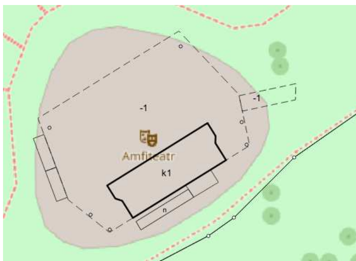
Zrzut ekranowy z aplikacji QGIS z wykorzystaniem wtyczki Qmapa. Przedstawia błędnie zastosowany blok budynku „łącznik”.
