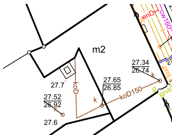
Zrzut ekranowy z aplikacji QGIS z wykorzystaniem wtyczki Qmapa. Przedstawia obiekt bazy GESUT nakładający się na konstrukcję budynku.
