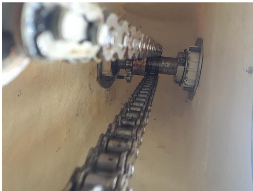
Zdjęcie 8. Kolumna steru – łańcuch mechanizmu sterowania PB poza zębatką
