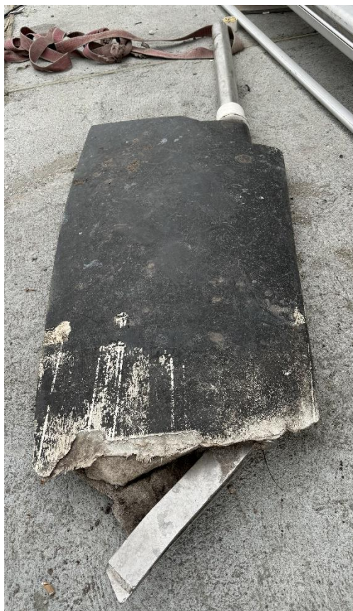
Zdjęcie 10. Zdemontowana uszkodzona płetwa sterowa jachtu „Maui”
