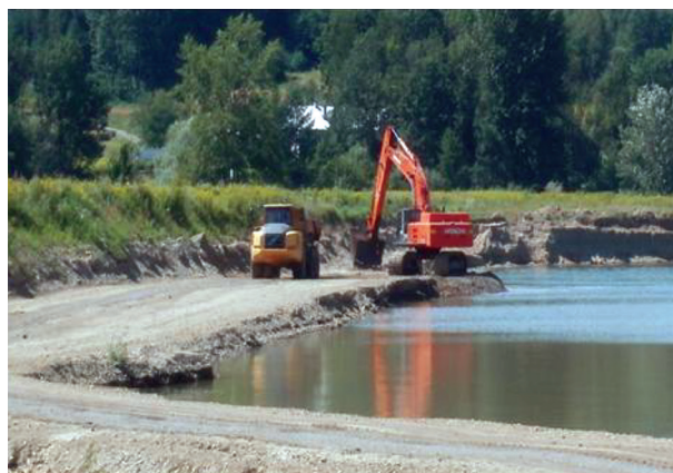
► Rys. 2. Urabianie złoża „Dęborzyn – Wisłoka” (układ koparka – samochód) [3]
