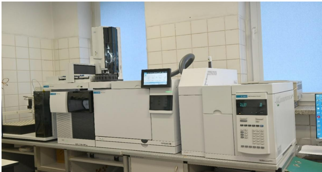
Zdjęcie: Chromatograf gazowy z analizą fazy nadpowierzchniowej (headspace) i detekcją spektrometrią mas
