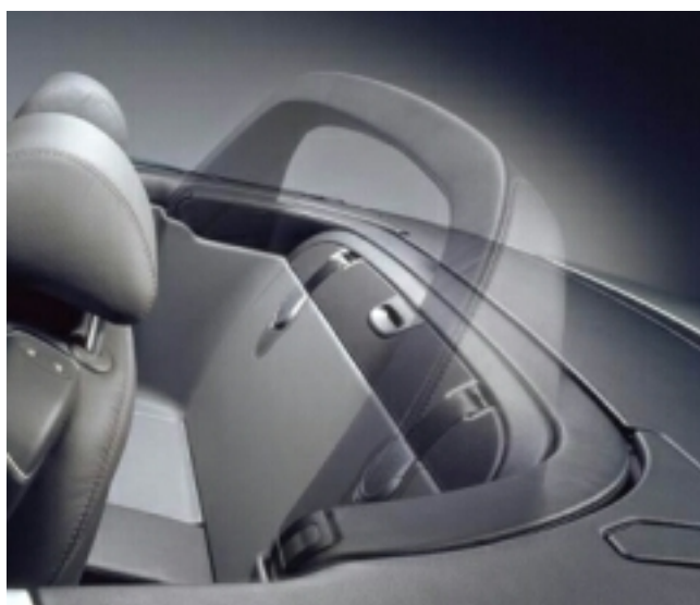
Fot. 3. Wysuwany pałak ochronny w momencie dachowania kabrioletu
