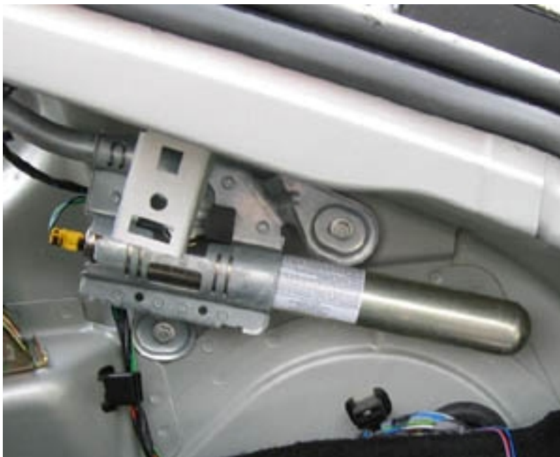
Fot. 6. Generator gazowy
