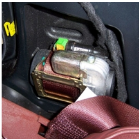
Fot. 11. Ładunek pirotechniczny ze zwijaczem
