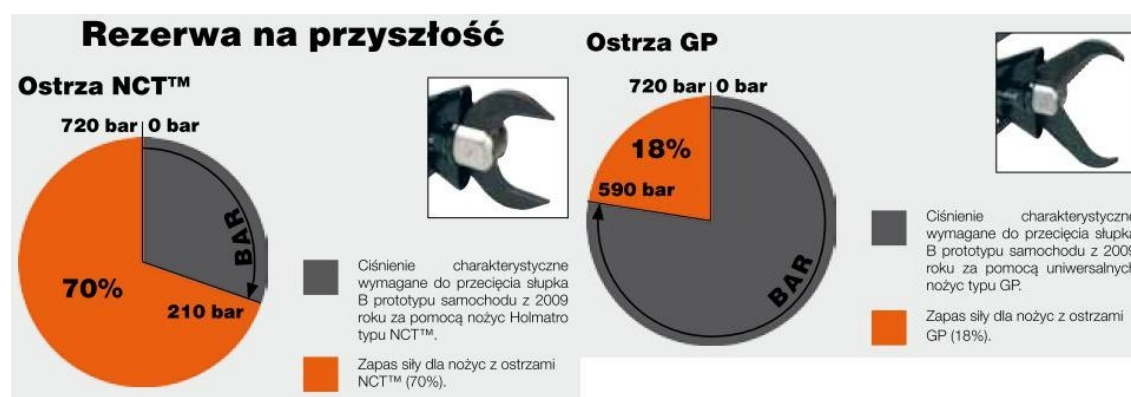
Rys. 17 Zwiększenie sił cięcia dzięki nożycom NCT
