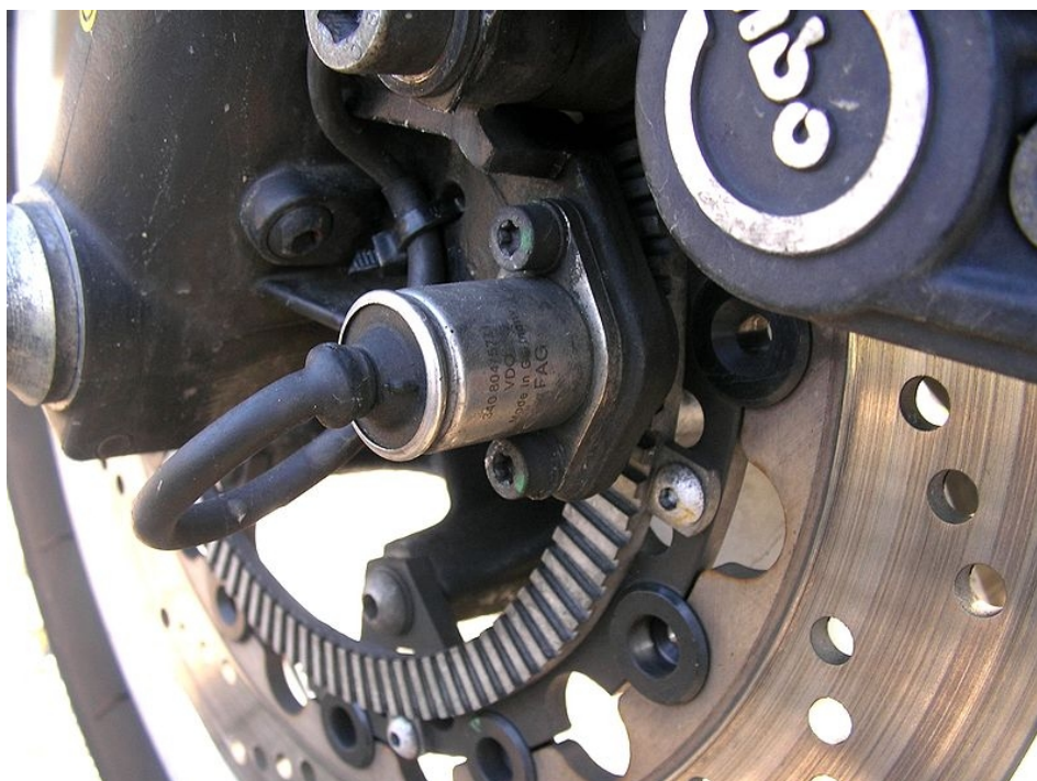
Fot. 1. Układ pomiarowy mierzący prędkość obrotową
