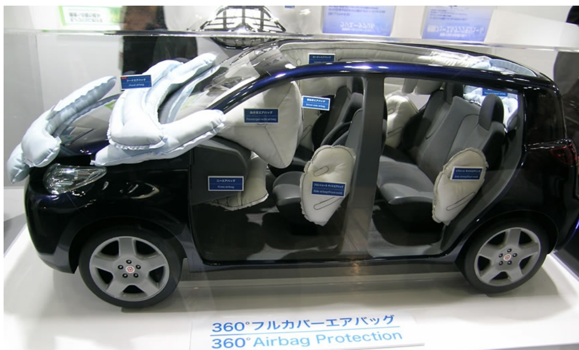
Fot. 10. Prototyp Toyoty zapewniający 360-stopniową ochronę
