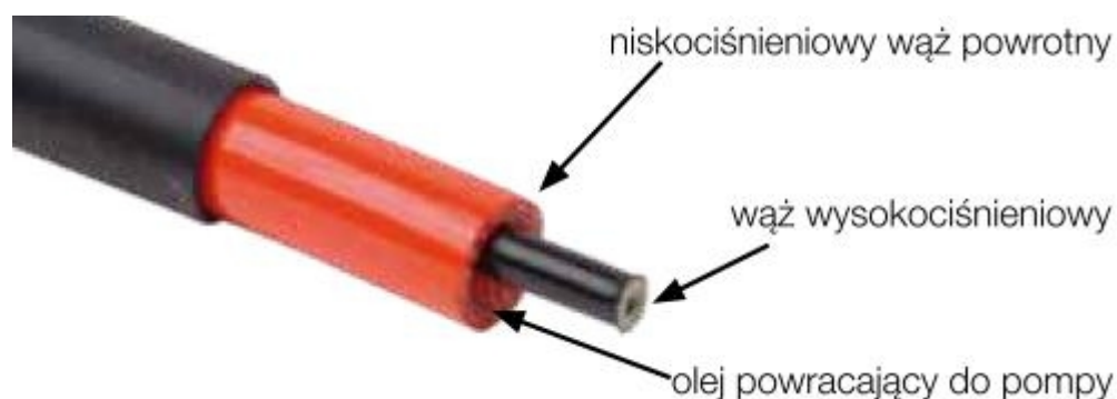
Fot. 24. Wąż hydrauliczny zbudowany w technologii CORE
