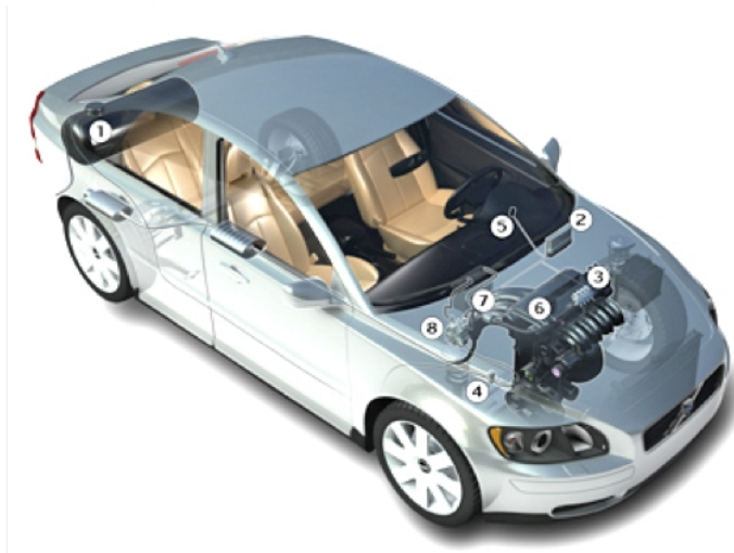
Rys. 9. Rysunek samochodu z rozmieszczonymi elementami instalacji LPG
