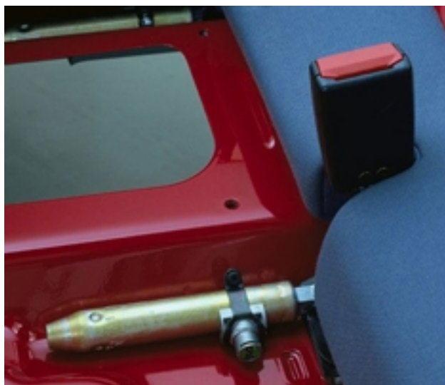
Fot. 12. Ładunek pirotechniczny umiejscowiony przy zamku
