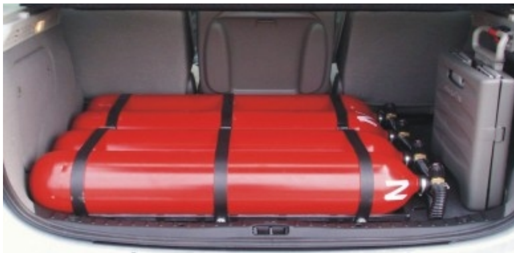
Fot. 18 Zbiorniki CNG zamontowane w bagażniku pojazdu
