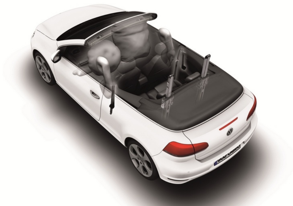
Fot. 2. System ochrony przed skutkami dachowania w kabrioletcie
