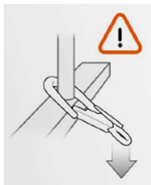
Rysunek 18. Niepożądana sytuacja, w której doszło do przyłożenia siły w kierunku niszczącym łącznik poprzez jego łamanie
