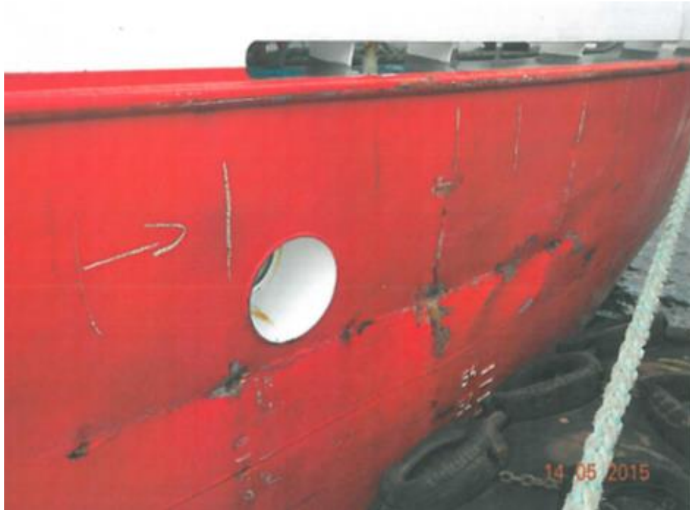
Zdjęcie nr 4. Uszkodzenia statku „Fast Jef”
