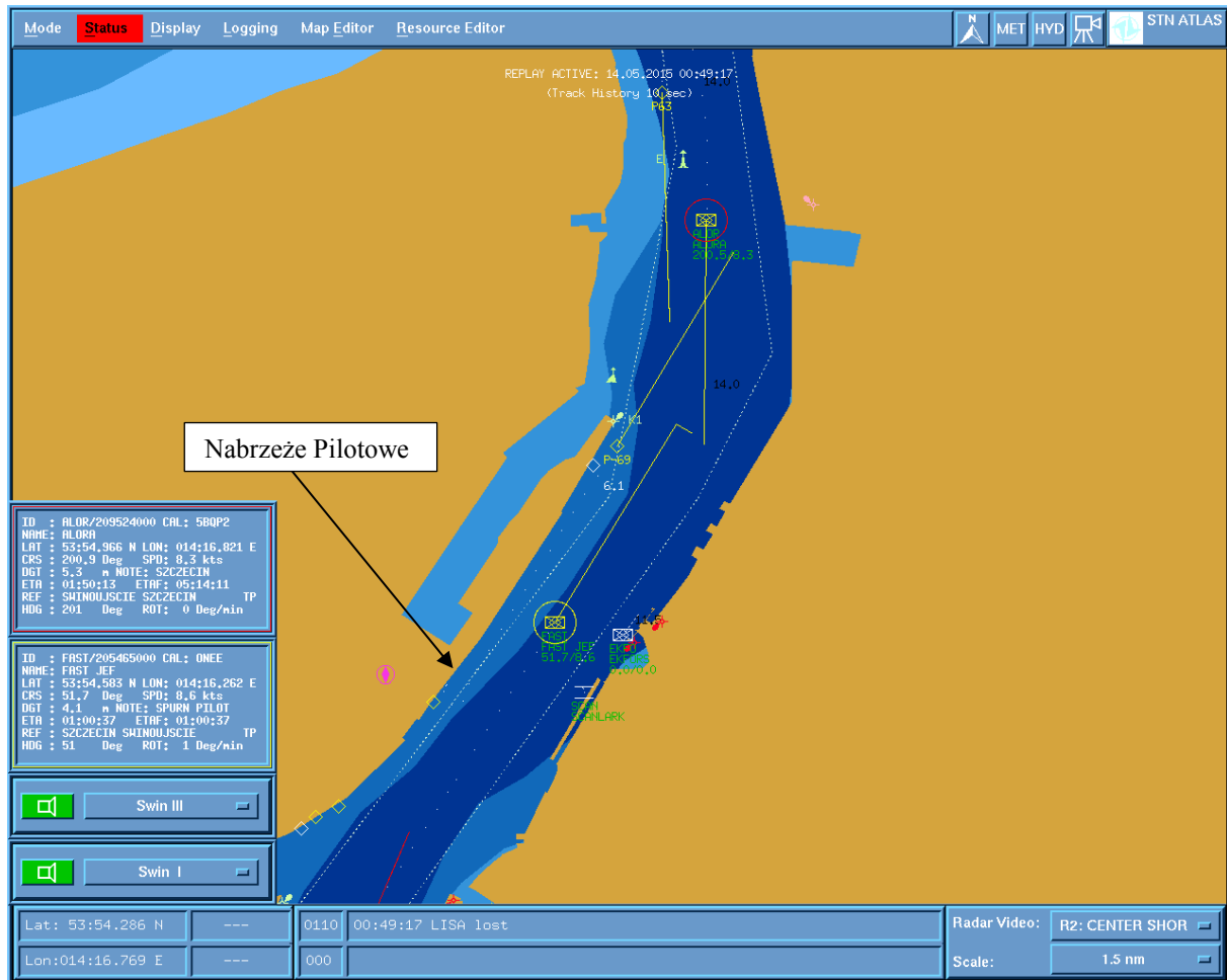
Rysunek 2. Obraz ech radarowych statków „Fast Jef” i „Alora” znajdujących się w odległości około 5 kabli od siebie
