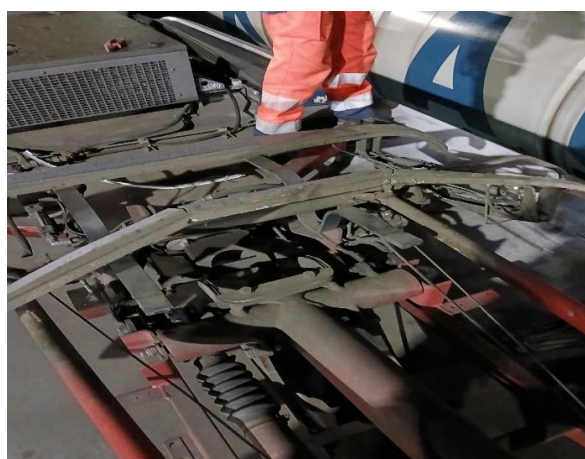
Zdjęcie 15 - Widok uszkodzonego pantografu na lokomotywie EU160-016 (źródło: materiał przekazany przez komisję kolejową)
