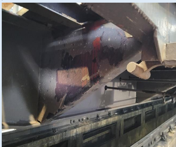
Zdjęcie 18 - Skutki zdarzenia - ślady wybuchu na podwoziu wagonu platformy (źródło: materiały przekazane przez komisję kolejową)
