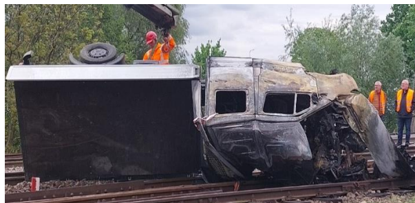
Zdjęcie 2 - Skutki zdarzenia - uszkodzony samochód ciężarowy z naczepą, rozrzucony ładunek (źródło: materiał własny PKBWK)
