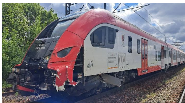
Zdjęcie 3 - Skutki zdarzenia - widok uszkodzeń pojazdu kolejowego 22WEg-018 (źródło: dokumentacja z POLREGIO S.A.)
