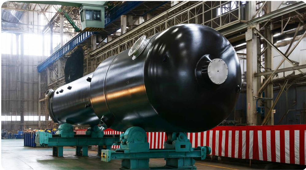
Fot. 1. Wytwornica pary (źródło: MHI Delivers 100th Steam Generator for Nuclear Power Plant Use – Unit Goes to Hokkaido Electric Power's Tomari-3 Power Plant, 2007-10-23 [37]) ( https://www.mhi.com/news/200710231202.html – dostęp 13.05.2026 r. Cyt. za A. Kochmański, K. Zasada, Przepisy, technologie i urządzenia w obszarze energetyki jądrowej, Inspektor – Technika i Bezpieczeństwo, Energetyka jądrowa, wydanie specjalne – październik 2025, s. 33 [28].).
