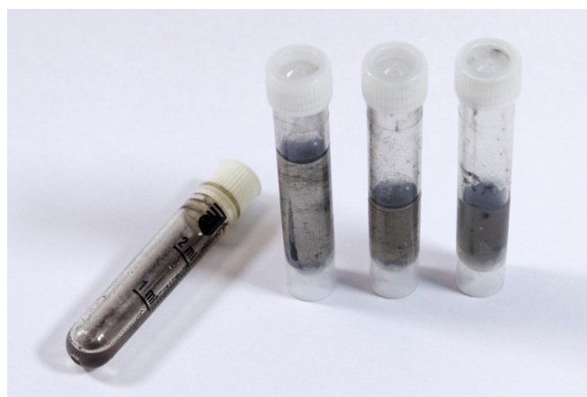
Fot. 1. Czarna zawieszyna grafenu w wodzie po redukcji roztworu GO w źródle promieniowania gamma Gammacell 5000 (antyutleniacze: bisfenol i dodatek piwa Kasztelan) (źródło: IChTJ).
