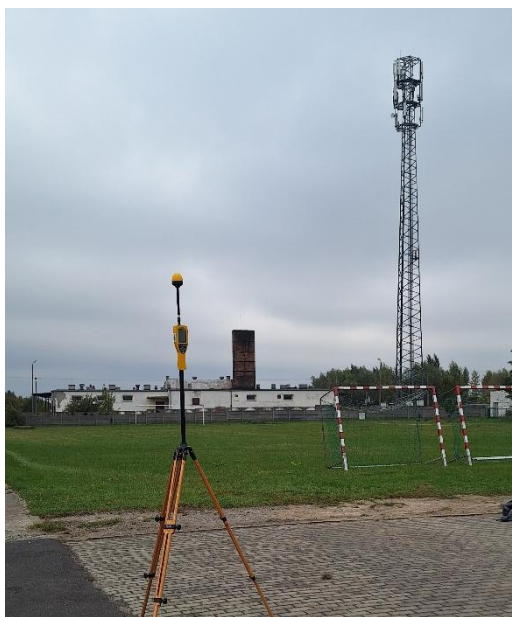
Fot.1. Przykładowe punkty pomiarowe poziomów pól elektromagnetycznych w środowisku (źródło: CLB w Bydgoszczy)
