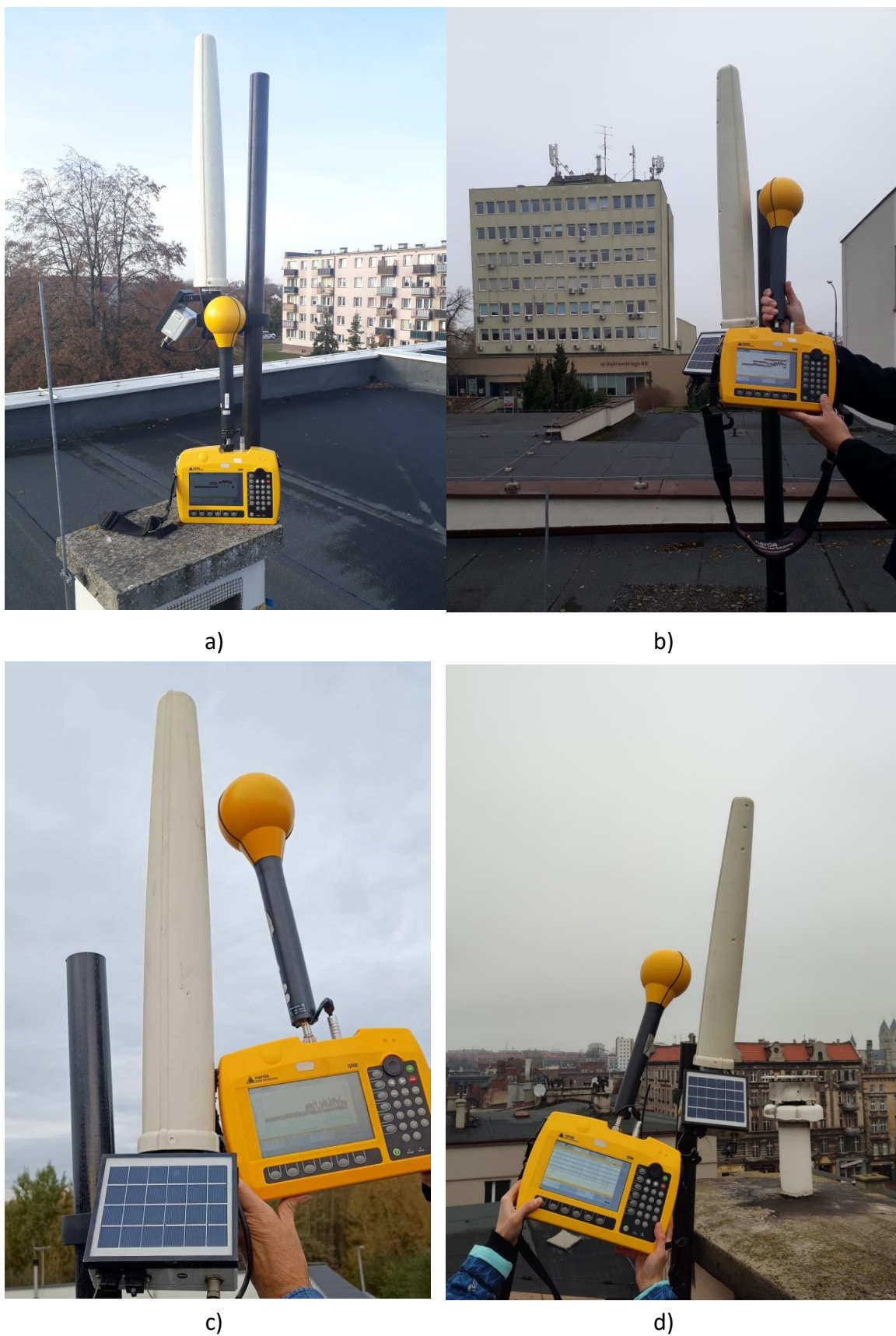
Rys. 5 Pomiary selektywne SRM-3600: (a) Płock, (b) Piła, (c) Wrocław, (d) Bytom
