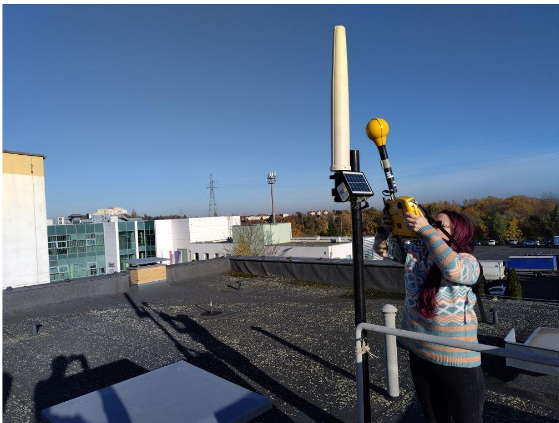
Rys. 8 Zakład Wodociągów i Kanalizacji w Szczecinie – pomiary selektywne SRM-3600
