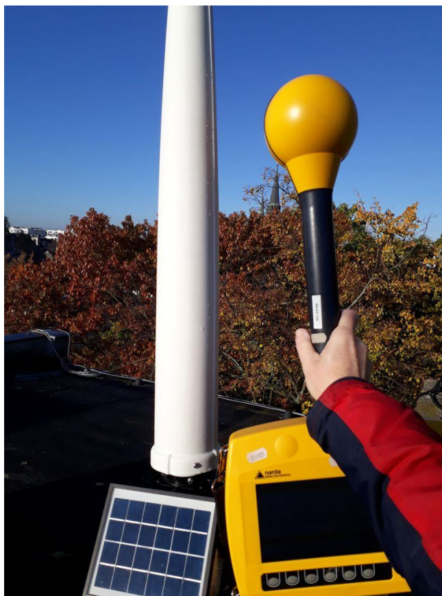
Rys. 8 Urząd Miasta Pruszków – pomiary selektywne SRM-3600
