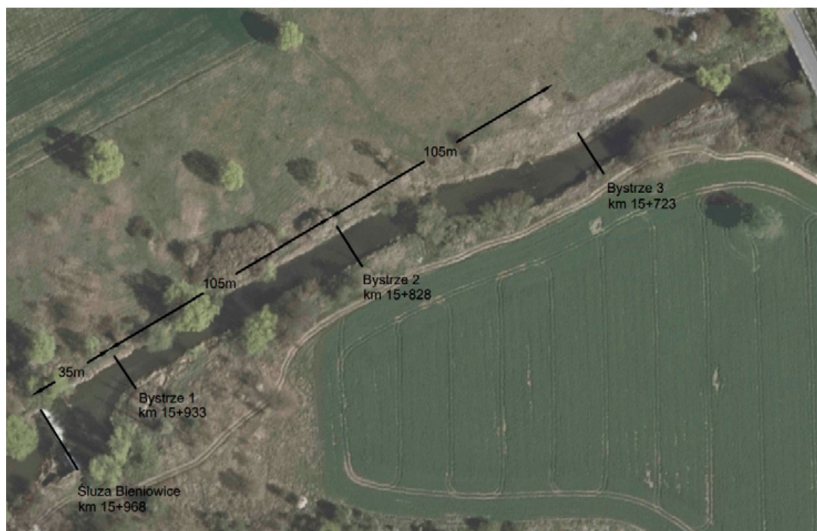
Ryc. 10. Szkic rozwiązania pokonania różnicy poziomu wody górnej a dolnej przez zastosowanie serii trzech bystrzy żwirowych o koronach w km 15+933, 15+828 i 15+723
