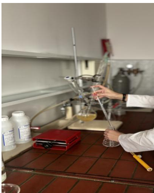
Fot. własna. Oznaczanie zawartości dwutlenku siarki w próbce żywności
