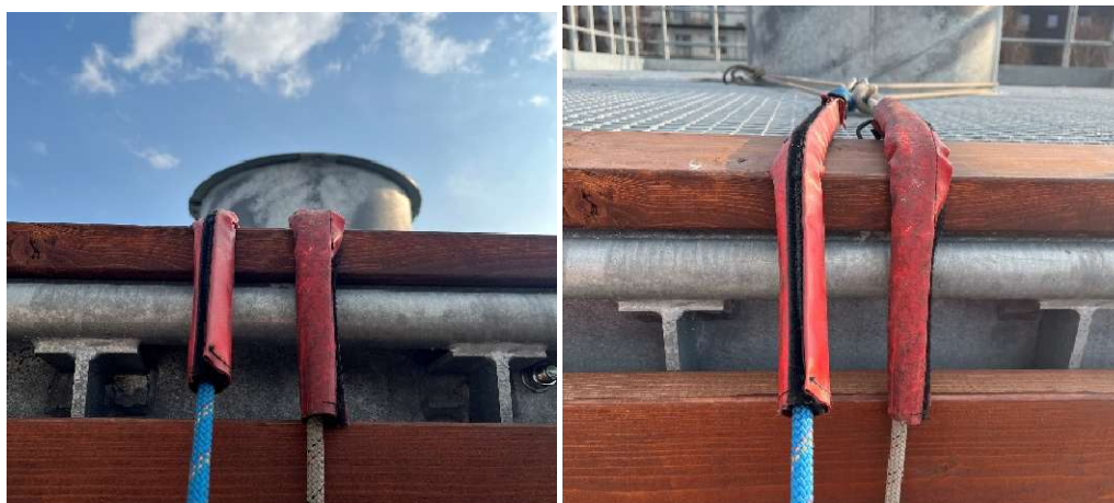
Rys. 6 Przykładowe użycie osłony ochronnej na linę
