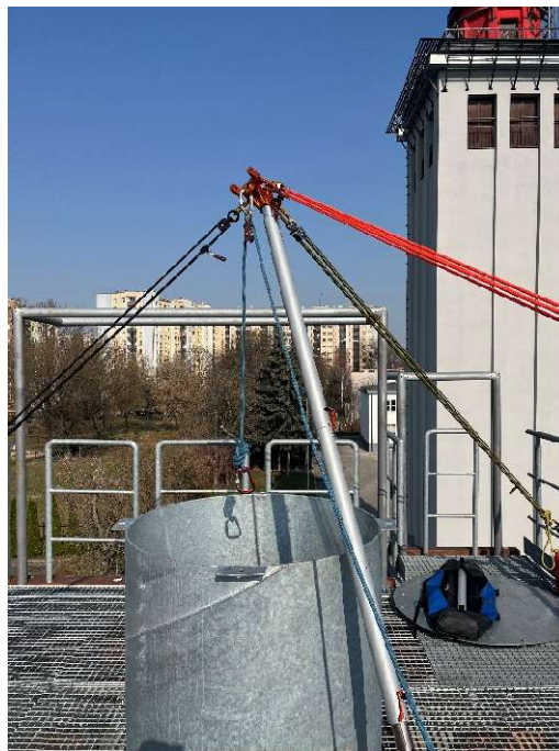
Rys. 14 Nieszablone wykorzystanie zestawu Vortex w konfiguracji monopod Gin Pole
