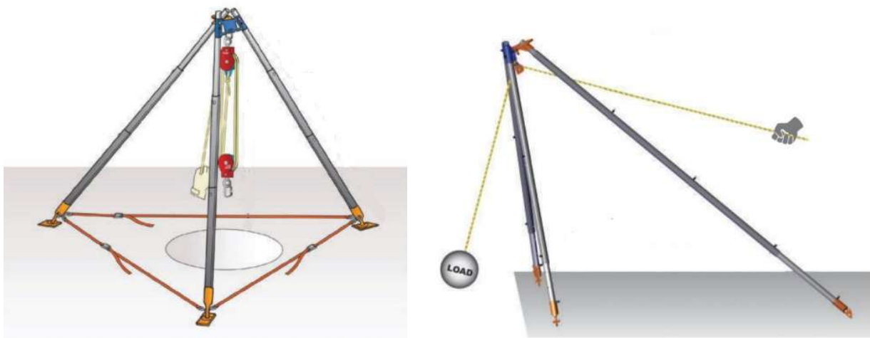
Rys. 12 Schemat wykorzystania trójnożu
