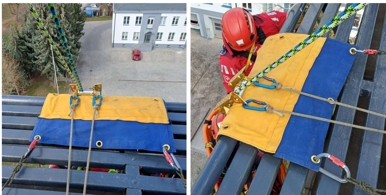
Rys. 10 Przykładowe użycie maty wraz z rolką krawędziową
