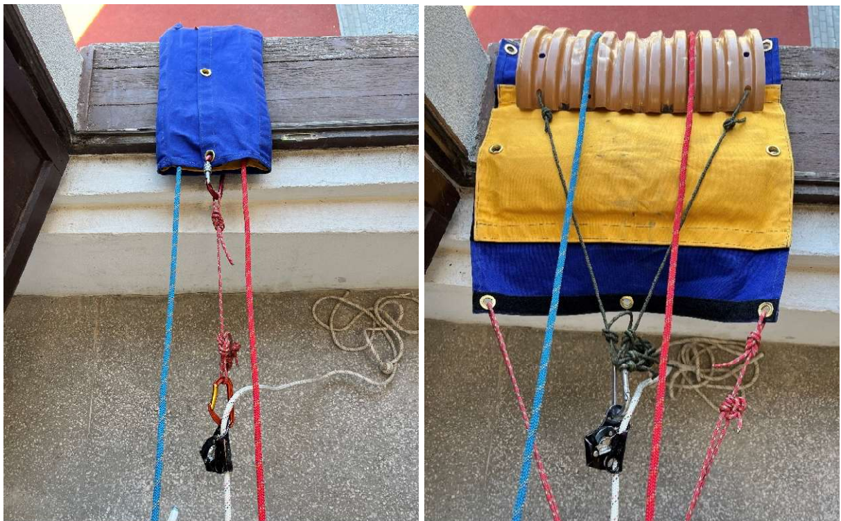
Rys. 8 Przykładowe użycie maty oraz maty i rury karbowanej wraz z jej mocowaniem
