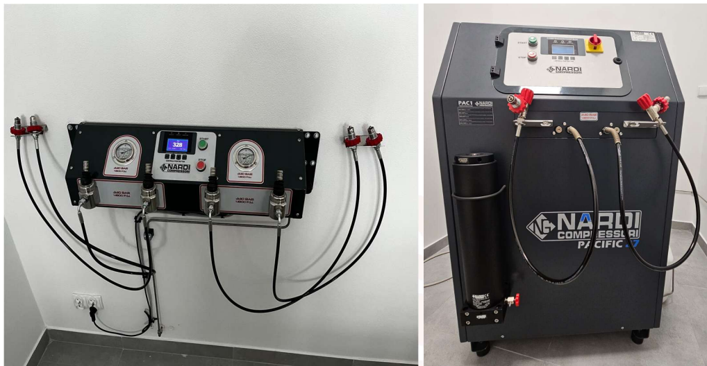
Fot. 25 Kompresor do ładowania butli z bankiem powietrza
