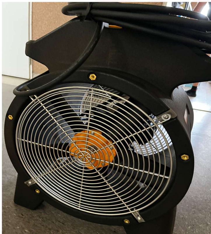
Fot. 30 Wentylator nadmuchowo wyciągowy
